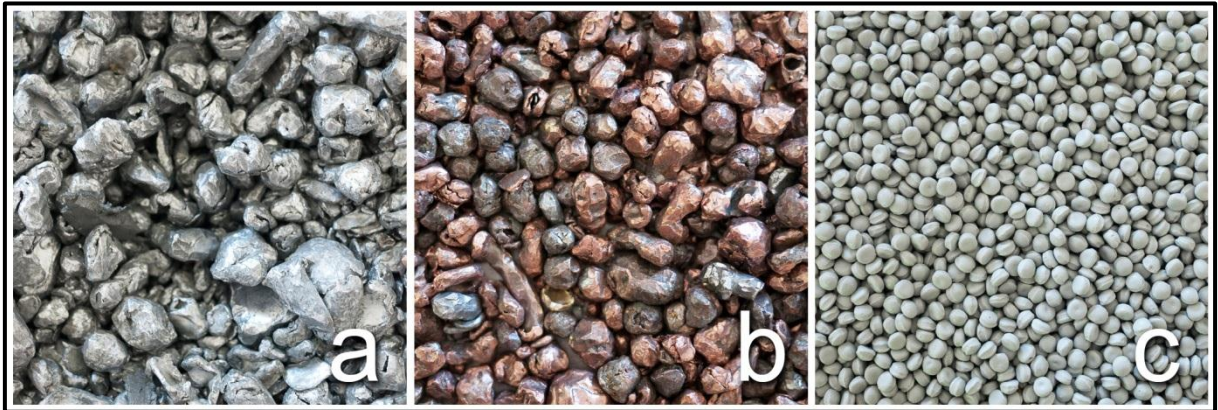
Abbildung 10: Fraktionen aus der Aufbereitung der Kunststoffnichteisenmetallmischung: a) Aluminium, b) Kupfer, c) Kunststoffgranulat
