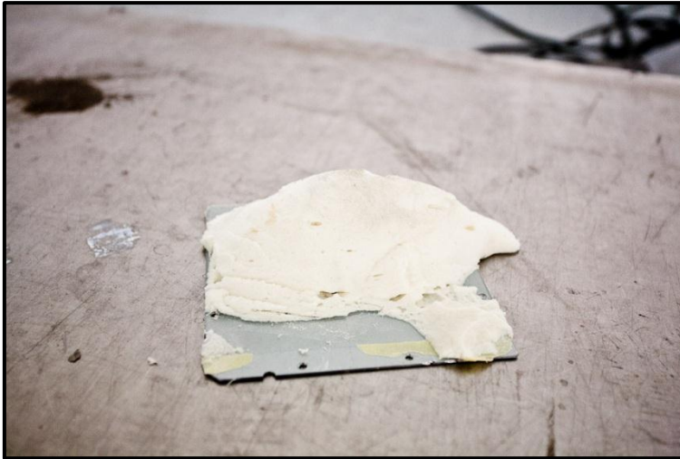
Abbildung 22: PU-Schaum-Anhaftungen auf Stahlplättchen
