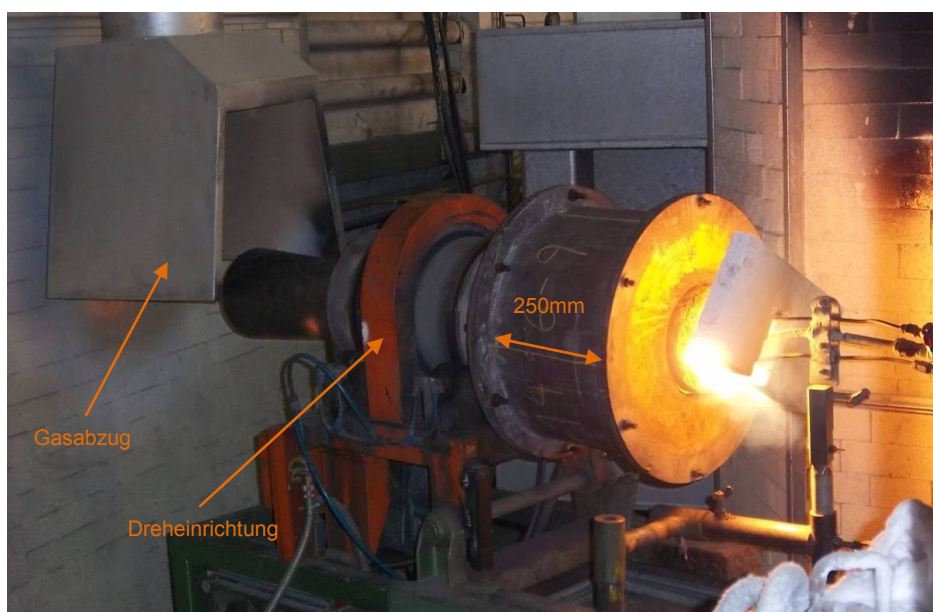
Abbildung 6-1: Versuchsaufbau am Standort der RHI AG in Göss
