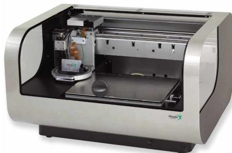
Abbildung 29: Drucker DIMATIX DMP 2831 [22]
