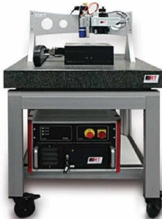
*Abbildung 37: Topographiemessgerät FRT MicroProf 200 [26]*
