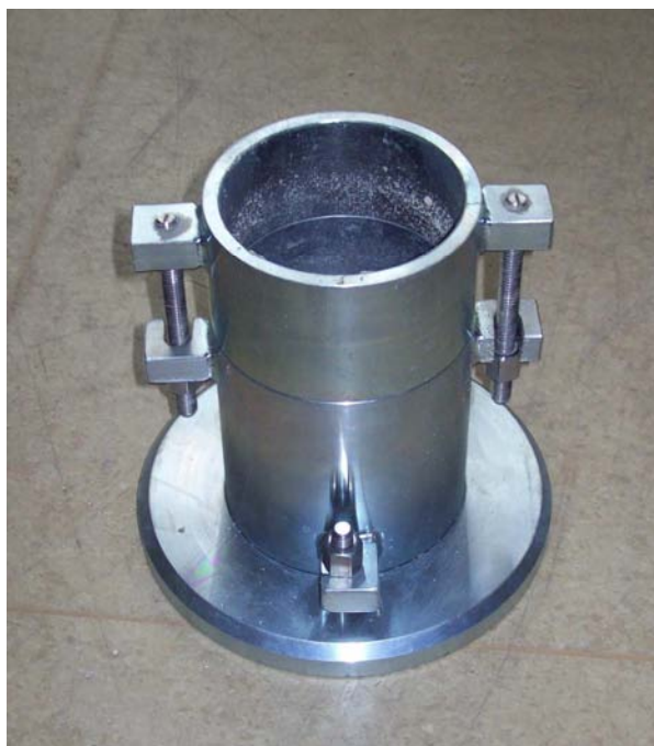
Abbildung 3.1.2: Proctortopf mit Aufsatzring
