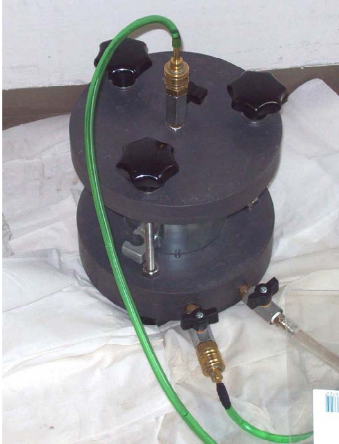
Abbildung 3.1.9: Anschlüsse der Wasserdurchlässigkeitszelle
