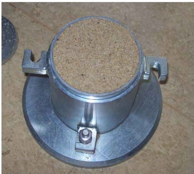
Abbildung 3.1.6: Proctortopf mit fertig verdichtetem Boden
