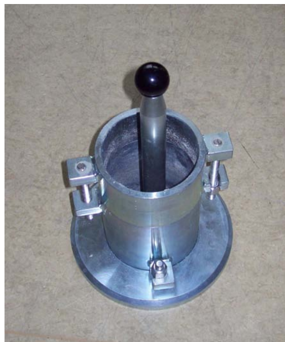
Abbildung 3.1.3: Proctortopf und Stahlstempel
