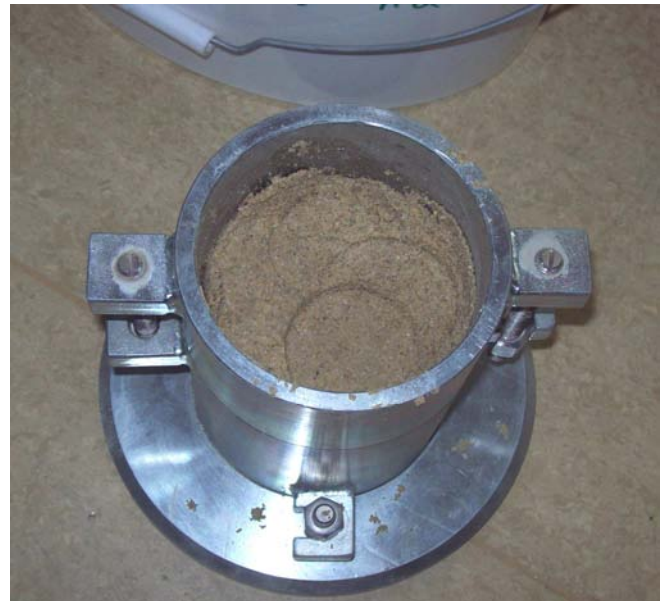
Abbildung 3.1.4: Fallgewicht mit Stempel Abbildung 3.1.5: Proctortopf mit verdichtetem Boden
