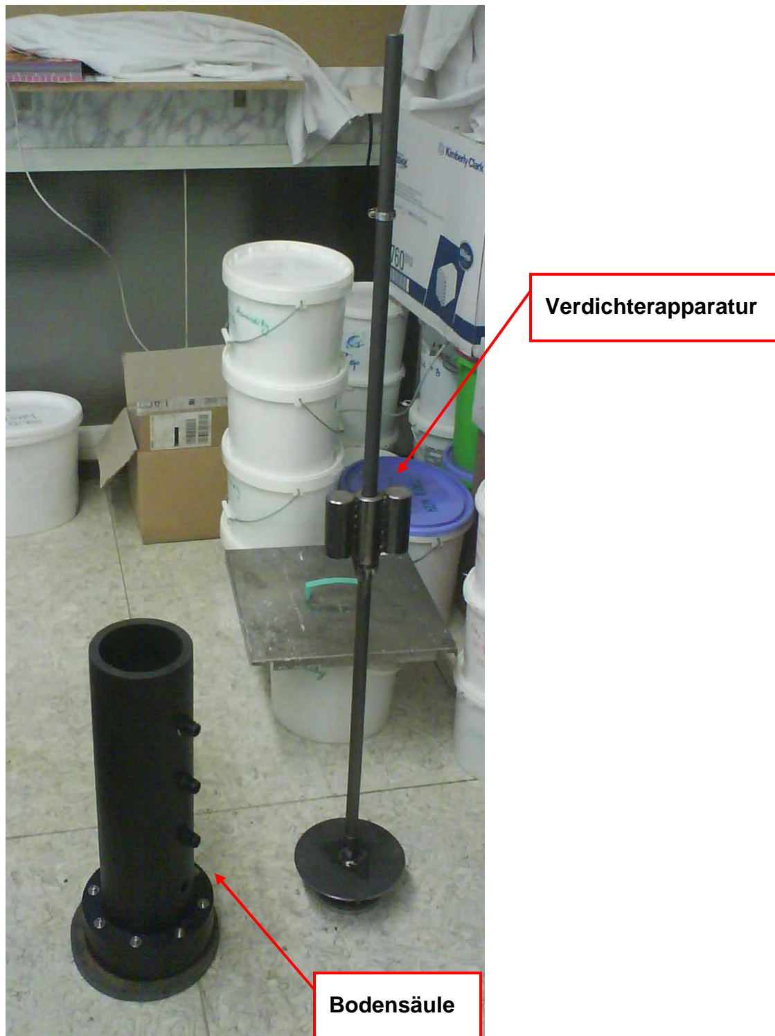
Abbildung 3.1.11: Bodensäule und Verdichterapparat
