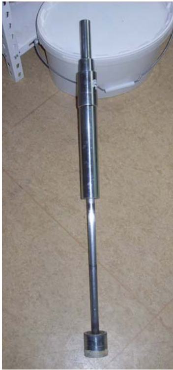
Abbildung 3.1.4: Fallgewicht mit Stempel Abbildung 3.1.5: Proctortopf mit verdichtetem Boden
