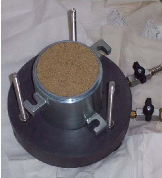
Abbildung 3.1.7: Einbau des Proctortopfes
