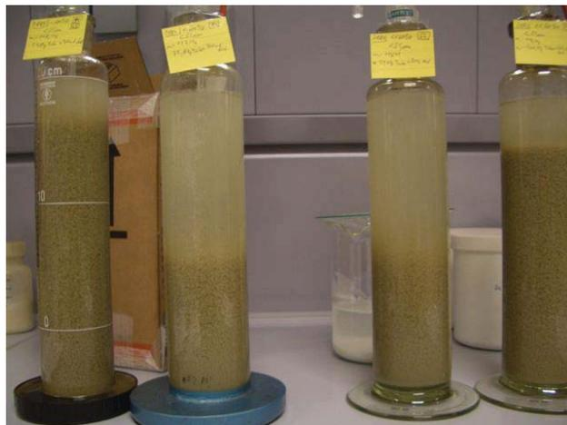
Abb. 6-26: Flockung der  $< 25 \mu\text{m}$  Proben des Zyklonversuchs in der Andreasen-Pipette
