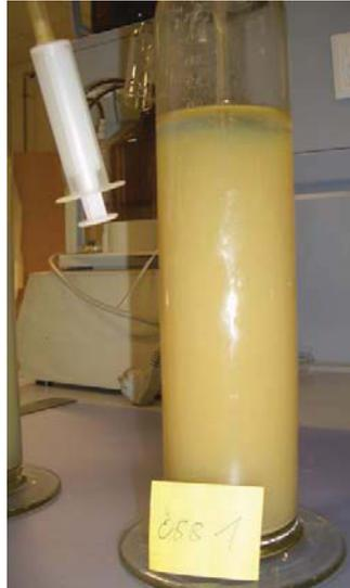
Abb. 3-7: Ende der Sedimentationsanalyse in der Andreasen-Pipette der Bodenprobe ÖBB1
