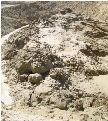
Abb. 3-5: Bohrfahlaustragsmaterial. Im vorderen Bereich schluffiger im hinteren Bereich sandiger Boden
