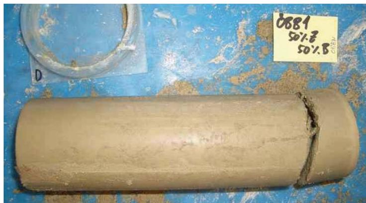
Abb. 6-3: Sedimentationskörper, nach 7 Tagen ausgepresst aus dem Acrylglasstandzylinder. Zusammensetzung der Probe: 50% Bodenprobe ÖBB1 und 50% Zement (Rolnjekt S 90 A) mit einer Feststoffmassenkonzentration von 600 g/l.
