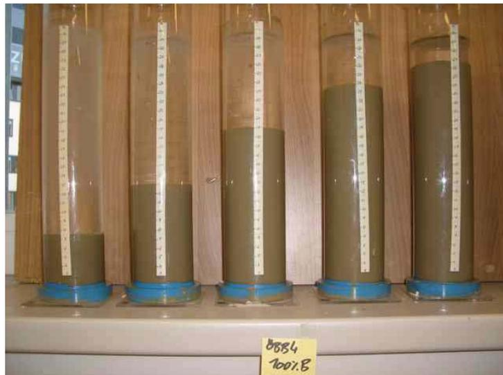
Abb. 6-8: Sedimentationsversuche der Bodenprobe ÖBB4 mit unterschiedlichen Feststoffmassenkonzentrationen (v.l.n.r. 150, 300, 450, 600, 750 g/l)
