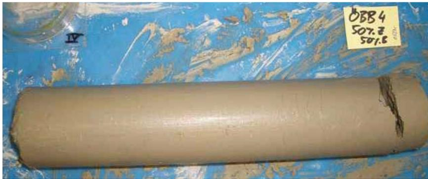
Abb. 6-9: Sedimentationskörper, nach 7 Tagen ausgepresst aus dem Acrylglasstandzylinder. Zusammensetzung der Probe: 50% Bodenprobe ÖBB4 und 50% Zement (Rolnjekt S 90 A) mit einer Feststoffmassenkonzentration von 600 g/l.
