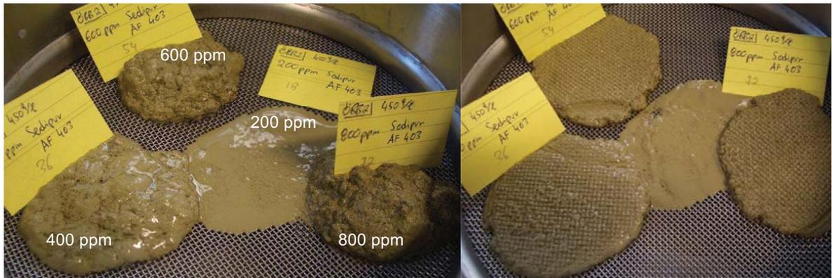
Abb. 6-23: In der linken Bildhälfte sind die geflochtenen Bodenprobe ÖBB2 (schluffig) unbelastet und auf der rechten Seite belastet mit einem zweiten kleineren Laborsieb der Maschenweite 1,25 mm. Es wurde die Sedipurkonzentration variiert.
