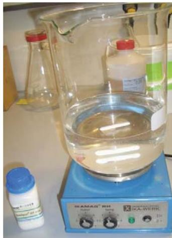
Abb. 4-7: Mittels Magnetrührer und Wärmeplatte in Suspension gebrachtes Flockungsmittel „Sedipur AF 403“ der Fa. BASF
