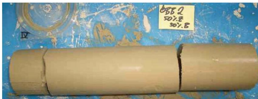
Abb. 6-6: Sedimentationskörper, nach 7 Tagen ausgepresst aus dem Acrylglasstandzylinder. Zusammensetzung der Probe: 50% Bodenprobe ÖBB2 und 50% Zement (Rolnjekt S 90 A) mit einer Feststoffmassenkonzentration von 600 g/l.
