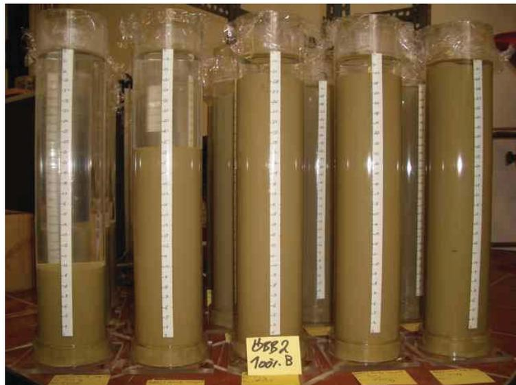
Abb. 6-5: Sedimentationsversuche der Bodenprobe ÖBB2 mit unterschiedlichen Feststoffmassenkonzentrationen (v.l.n.r. 150, 300, 450, 600, 750 g/l) 100 %
