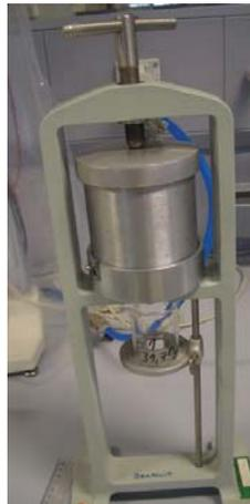
Abb. 4-4: Druckfiltrationszelle zusammengebaut
