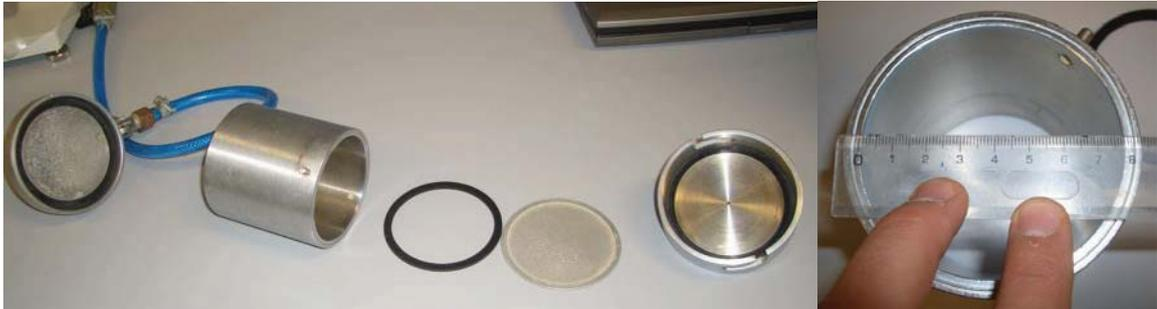
Abb. 4-3: Explosionsdarstellung der einzelnen Komponenten des Labordruckfiltrationsapparates
