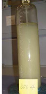
Abb. 3-13: Ende der Sedimentationsanalyse in der Andreasen-Pipette der Bodenprobe ÖBB4
