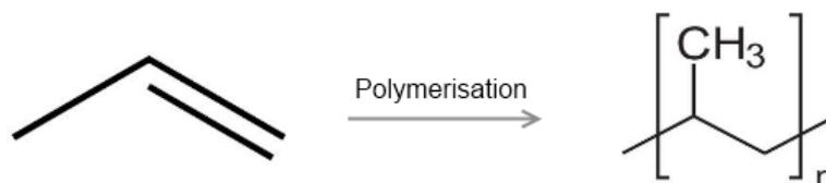
**Abb. 30:** Strukturformel der Monomer- (Propen) und der Polymereinheit (Polypropylen).
