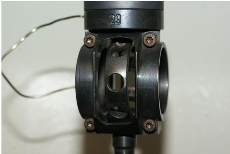
**Abb. 34:** Arretierungsvorrichtung der DMA/SDTA 861 (12N).
