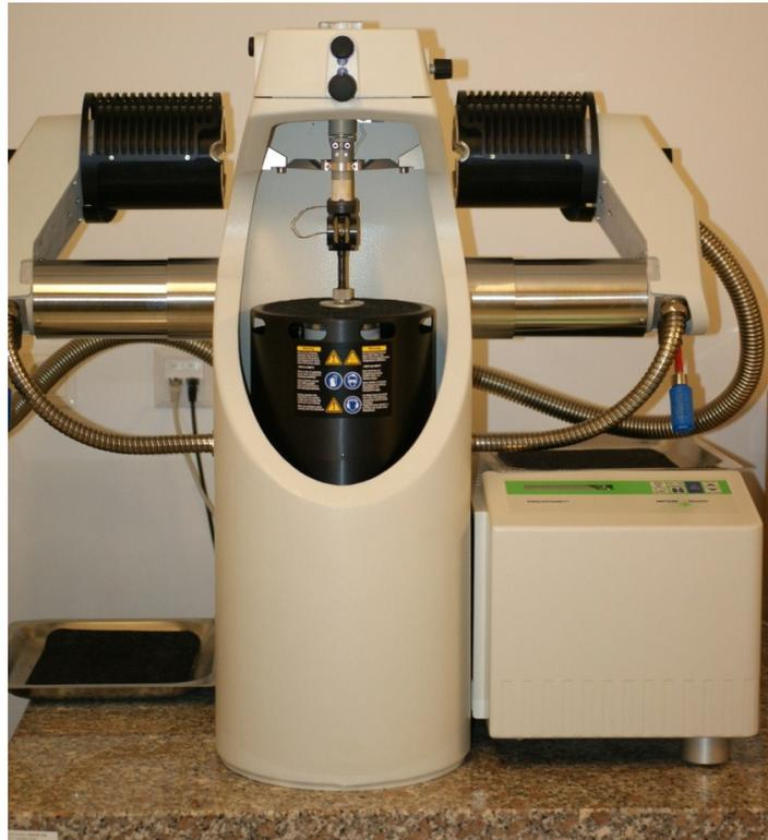
**Abb. 33:** DMA/SDTA 861 (12N) der Firma Mettler-Toledo.
