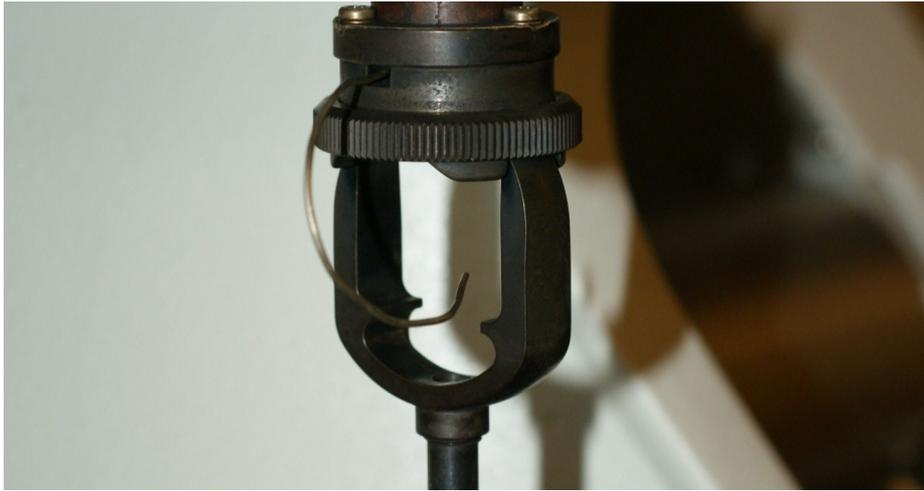
**Abb. 35:** Arretierungsvorrichtung der DMA/SDTA 861 (40N).
