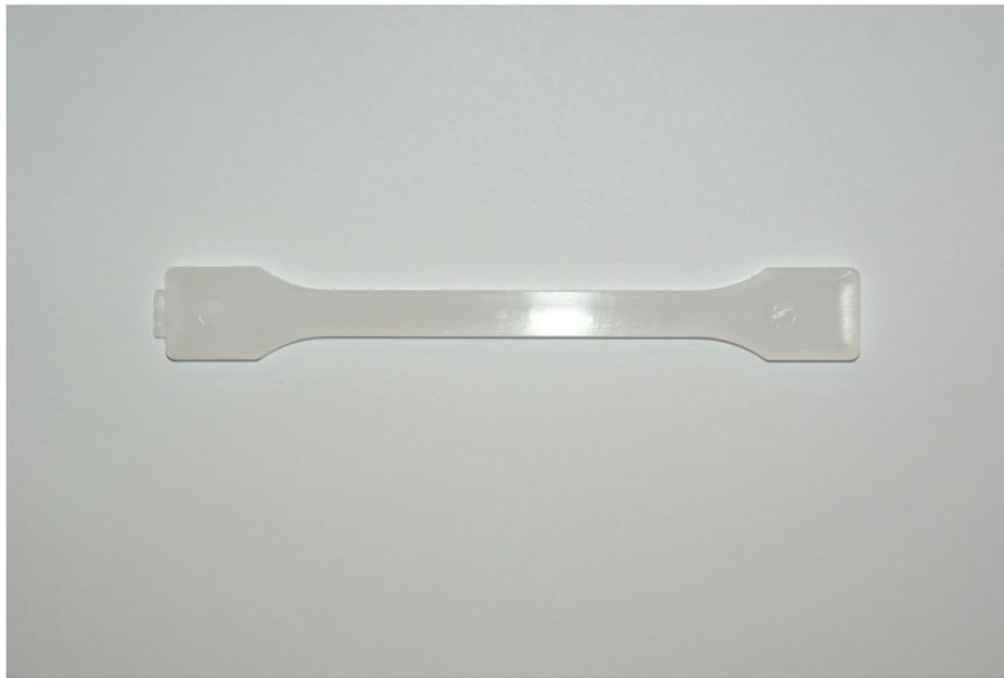
**Abb. 31:** Mehrzweckprüfkörper aus PP.
