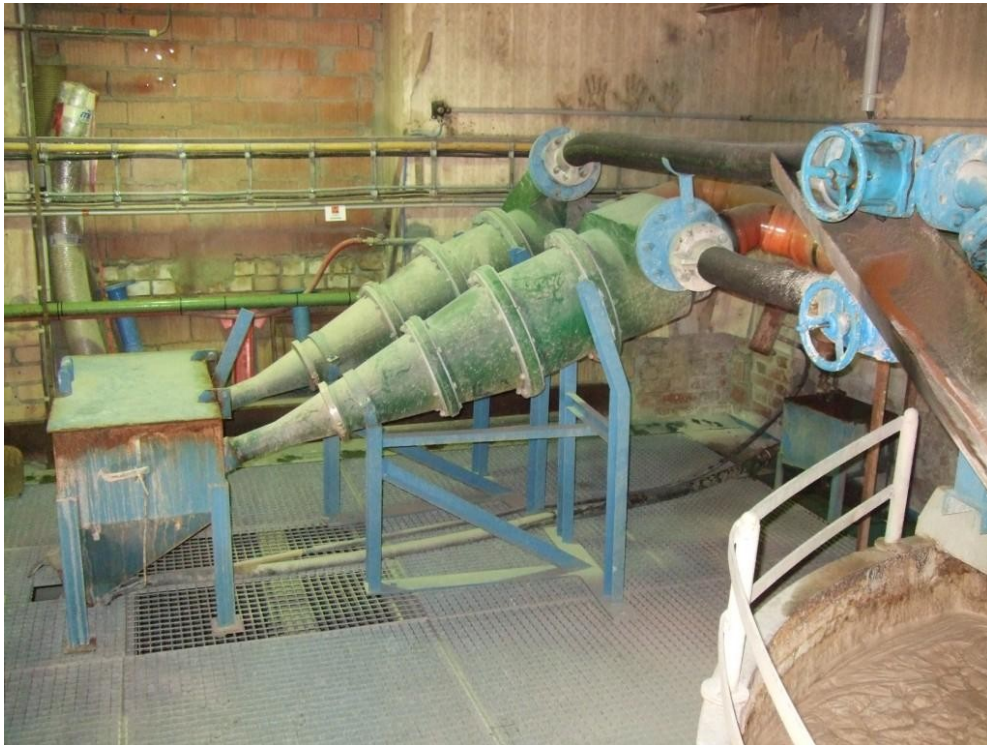
Abbildung 8: Hydrozyklonstufe der Mahlung, im Vordergrund ist das Konditioniergefäß erkennbar.
