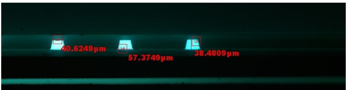
Abbildung 45: Schlichtbild (10-fach) 50 \mu\text{m} Wellenleiter mit 200 \mu\text{m} Abstand bei 300 \text{ mJ/cm}^2 Belichtungsintensität
