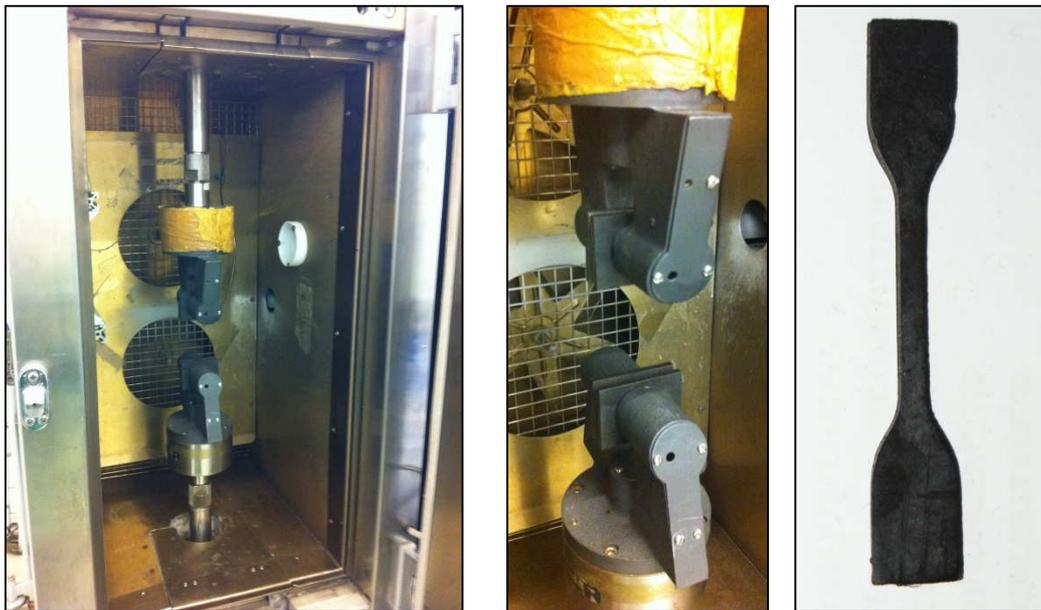
**Abb. 3.4:** Einspannvorrichtung (links, mitte) und Prüfkörper für die Zugprüfung (rechts)
