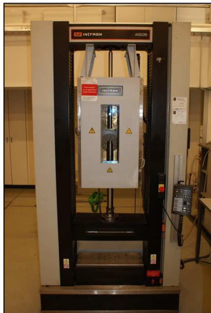
**Abb. 3.3:** Verwendete Zugprüfmaschine INSTRON 4505
