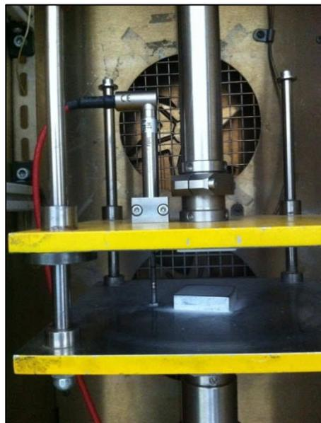
**Abb. 3.5:** Einspannvorrichtung für die Druckprüfung
