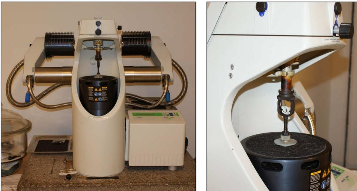
**Abb. 3.1:** Verwendeter Prüfaufbau für die dynamisch mechanische Analyse
