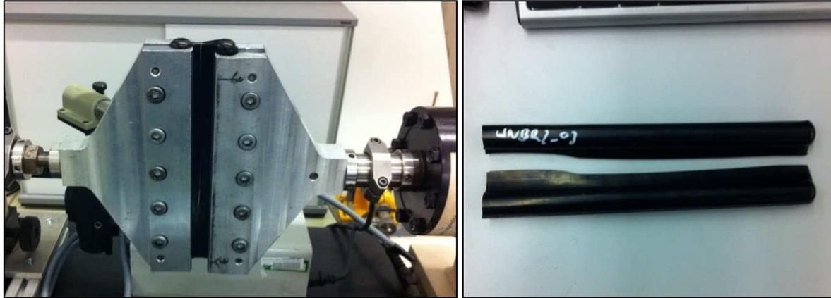
**Abb. 3.7:** Einspannvorrichtung (links) und Prüfkörper für die planare Prüfung (rechts)
