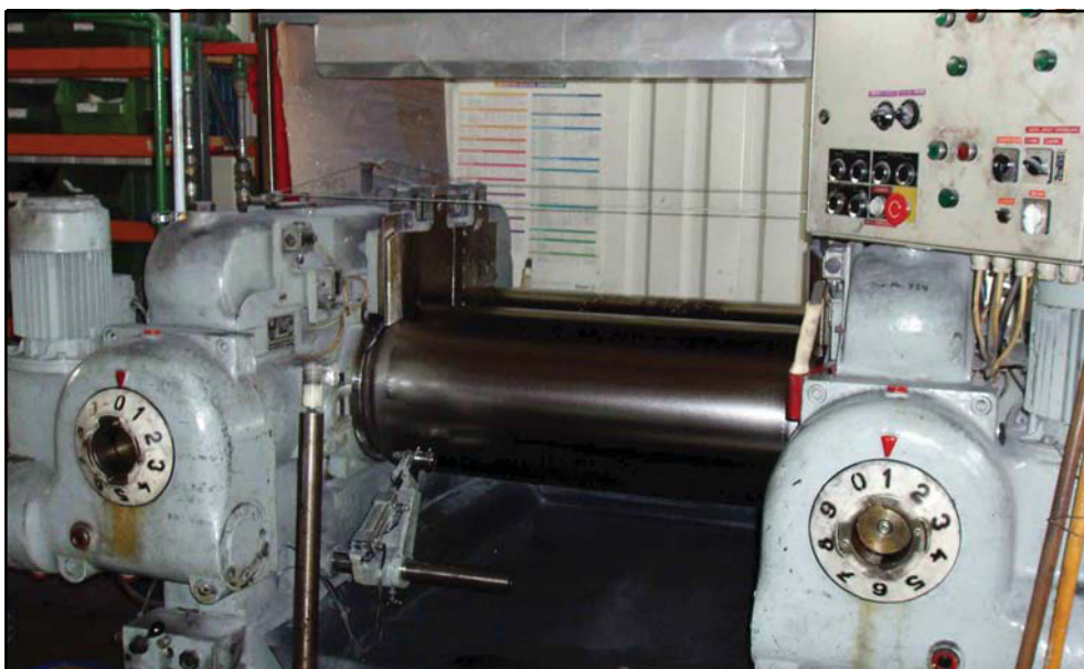
Abbildung 2.1: Walzwerk bei Fa. Erwin Mach Gummitechnik (Hirm, A).
