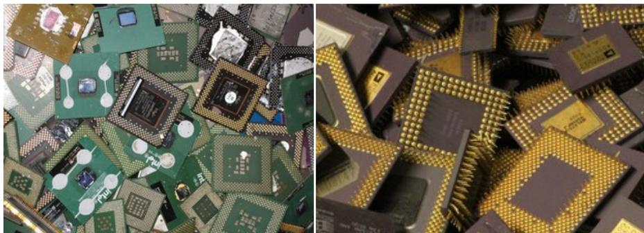
Abbildung 10: Kunststoffprozessoren mit Goldfüßen, Keramikprozessoren mit Goldfüßen [24]
