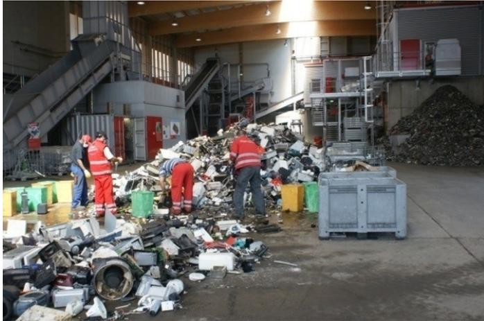
Abbildung 24: Vorsortierung am Boden der Halle
