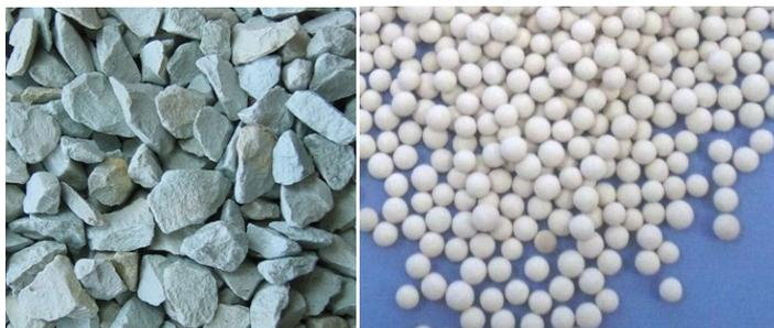
Abbildung 39: Natürlich gebrochener und synthetischer Zeolith [71], [72]
