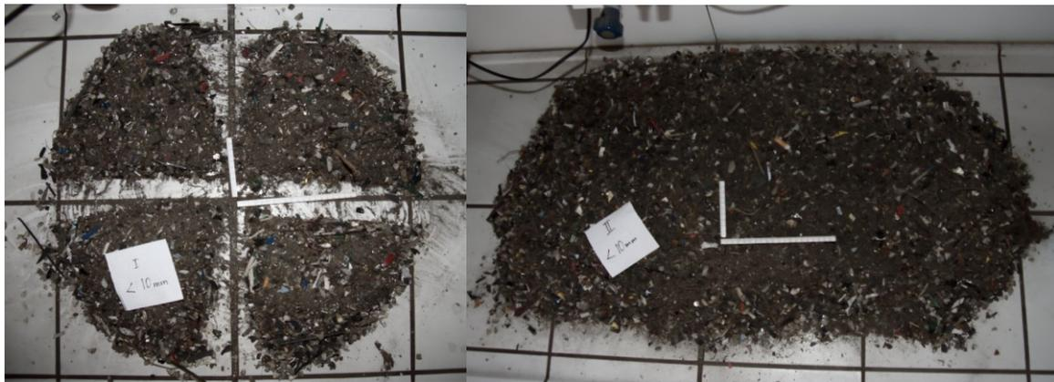
Abbildung 37: Proben V (4 kg) und VI (17 kg) vor Verjüngung
