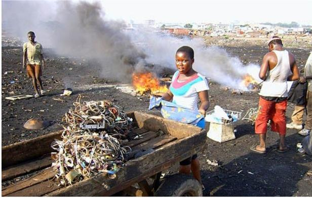
Abbildung 19: Kupfergewinnung durch das Abbrennen von Kabeln in Ghana [54]
