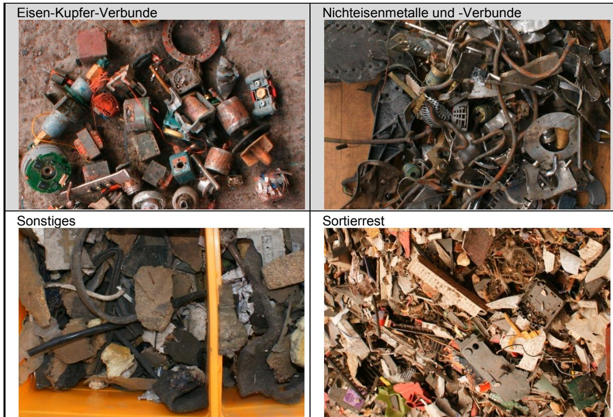
Die erste Probe, die sortiert wurde, bestand aus dem Durchlauf der Probe II und umfasste 227 kg, die auf ein Mal gezogen wurden. Proben V und VI bestanden aus je 3 mal 50 kg Einzelproben. Bei der ersten Probe fielen über 100 kg Sortierrest an, bei der Probe V waren es nur 12 kg und bei Probe VI 50 kg. Die Ergebnisse dieser Grobsortierung sind in Abbildung 31 dargestellt.
