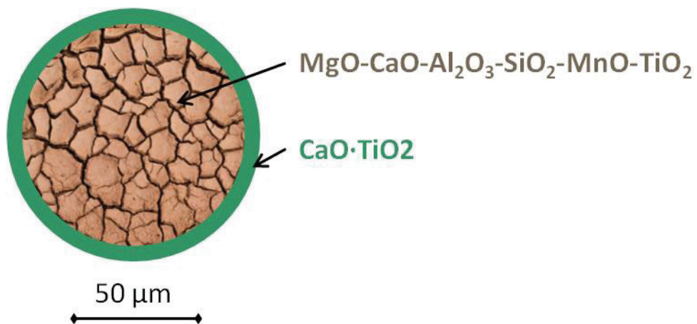
Abbildung 3-6: Schematische Darstellung eines mehrphasigen Einschlusses bestehend aus einem eingeschlossenen Schlacketropfen, der von CaO·TiO 2 umwachsen ist, nach [5].
