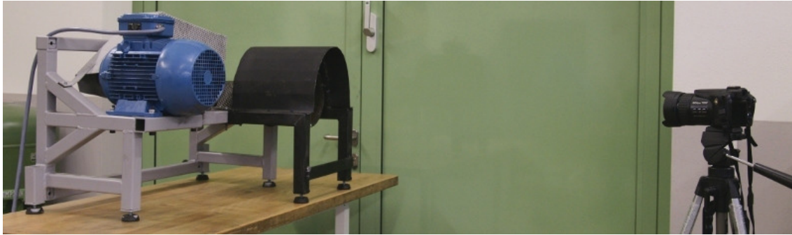
Abbildung 3-18: Versuchsaufbau im horizontalen Schleuderguss.
