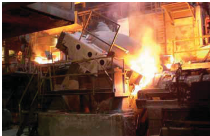
Abbildung 1-1: Einguss von GJS in eine Schleudergussmaschine.
