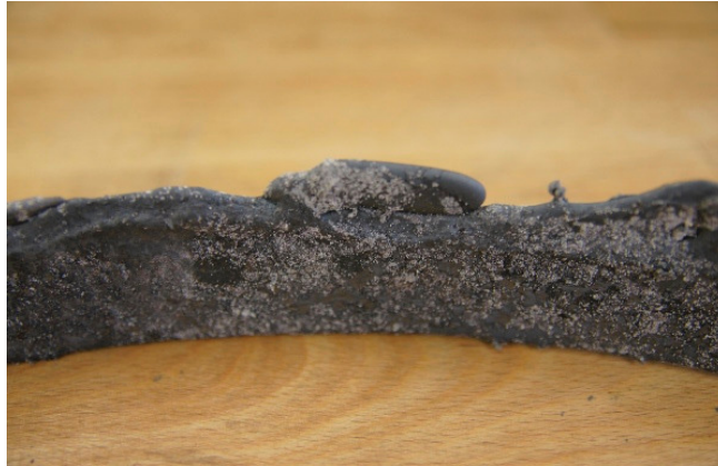
Abbildung 4-12: Teil eines Ringes, mit Schlichte gegossen.
