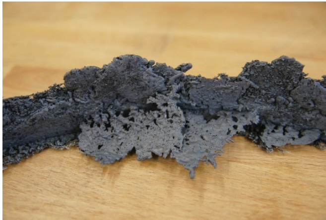
Abbildung 4-13: Teil eines Ringes, ohne Schlichte gegossen.
