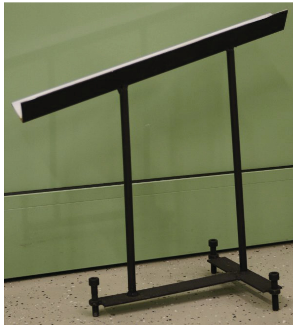
Abbildung 3-22: schräger Einguss für die offene Kokille.
