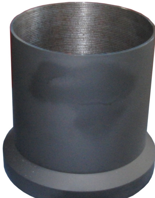
Abbildung 3-15: offene Kokille mit schwarzer Lackierung zur Temperaturmessung.
