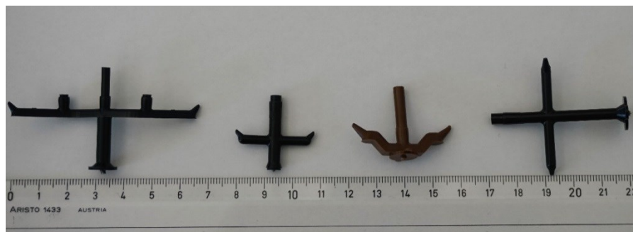
Abbildung 35: Typische Kuppelprodukte (Angüsse) aus dem Spritzgießverfahren
