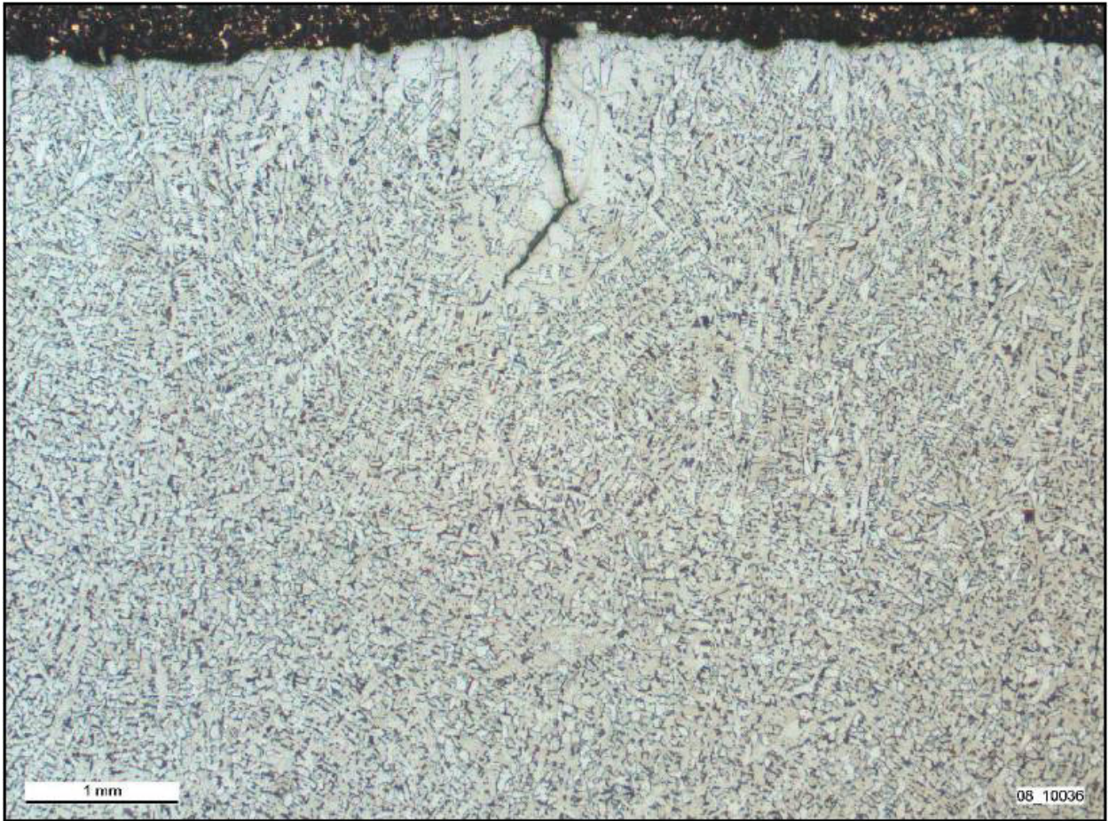
Bild 91: Riss2, Ätzung Nital 3%
