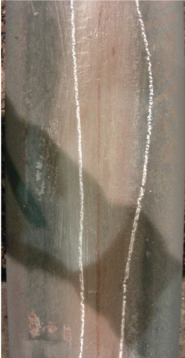
Bild 57: Zundergefüllter Flächenlängsriss, Stahlgruppe 5
