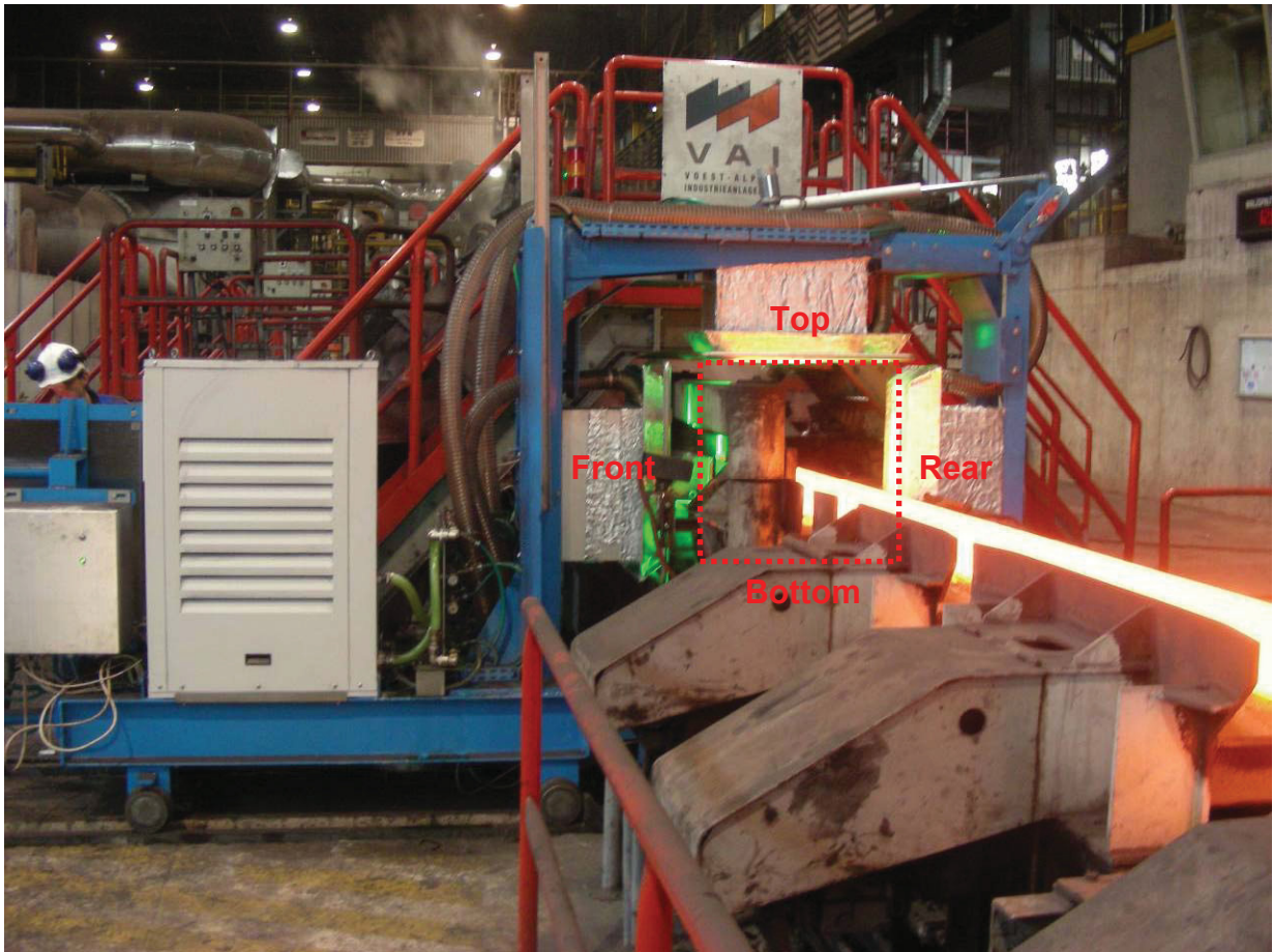
Bild 28: Sias - Anlage im Betrieb, Schematische Darstellung der vier Knüppelseiten
