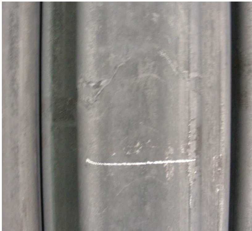
Bild 53: Massiver Querriss der sich bis in die Knüppelmitte erstreckt, Stahlgruppe 4
