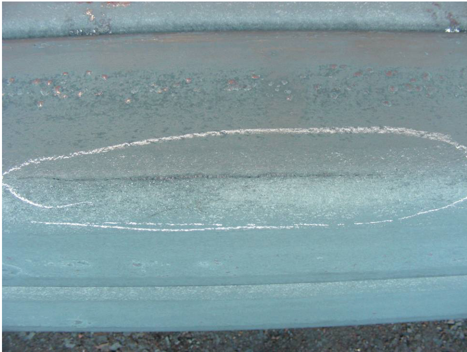
Bild 59: Teilweise mit Zunder gefüllter Kantenlängsriss, Stahlgruppe 2
