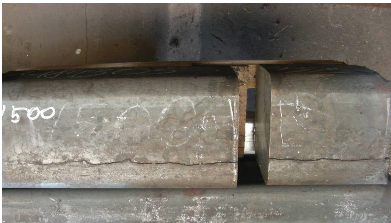
Bild 78: Flächenlängsriss starker Ausprägung, Stahlgruppe 2
