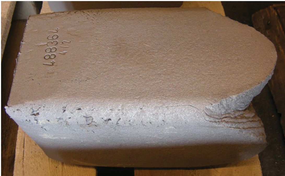
Bild 41: Gruppe von Kantenquerrissen auf Knüppel, Stahlgruppe 1
