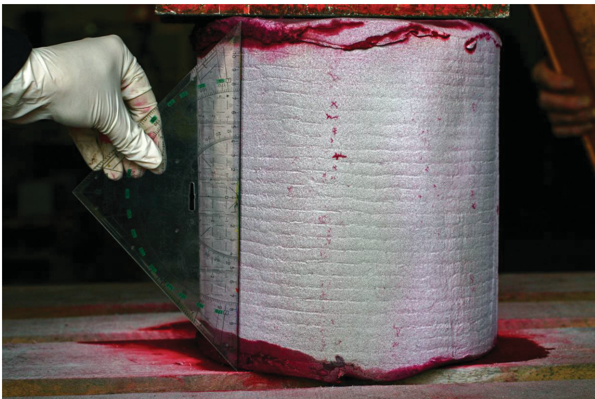
Bild 89: Vorblockprobe mit Netzwerkrissen nach der Farbeindringprüfung (rot)
