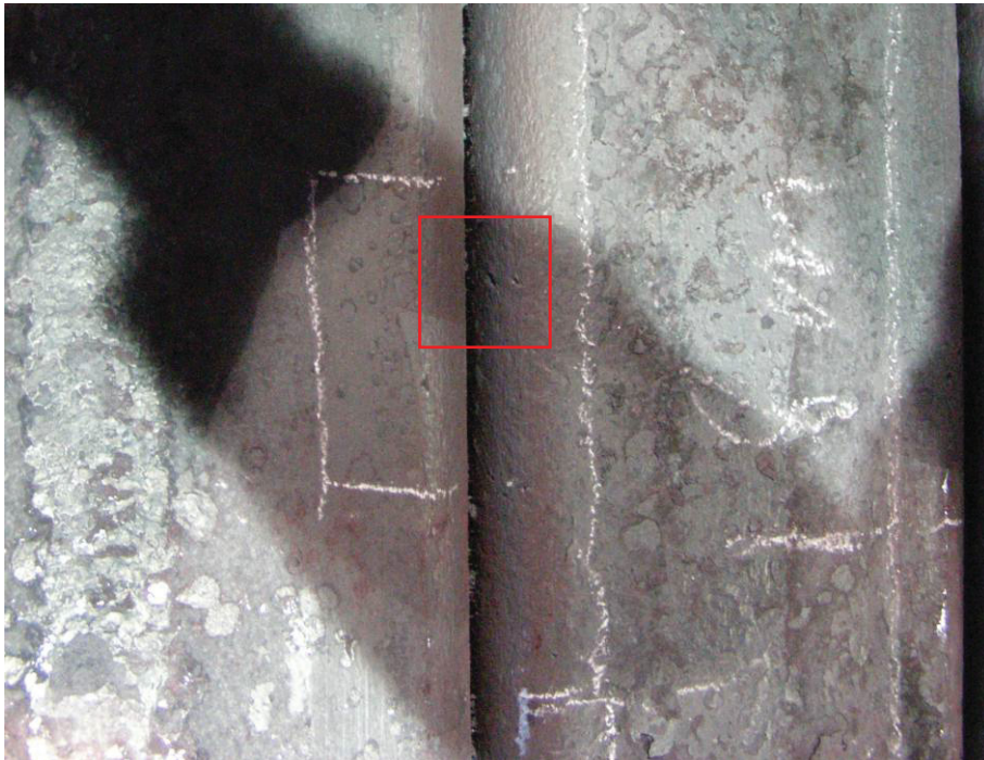
Bild 39: Kantenquerriss schwacher Ausprägung auf Knüppel, Stahlgruppe 1
