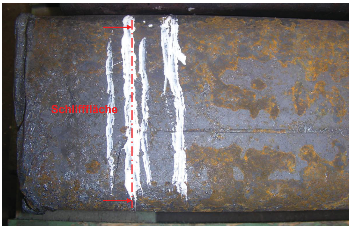
Bild 86: Schliffposition zur metallographischen Untersuchung
