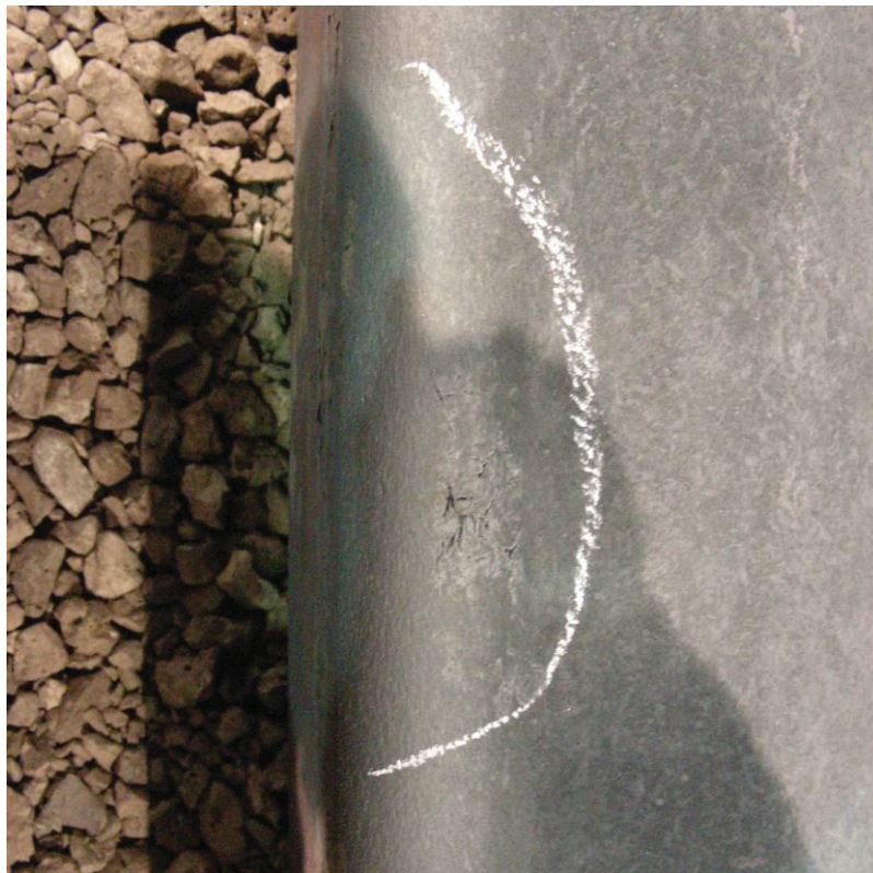
Bild 43: Netzförmiger Kantenquerriss auf Knüppel, Stahlgruppe 1
