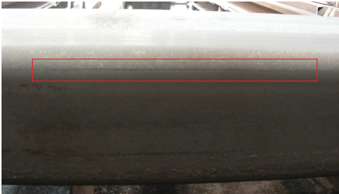
Bild 67: Riefe durch mechanische Beschädigung, Stahlgruppe 1
