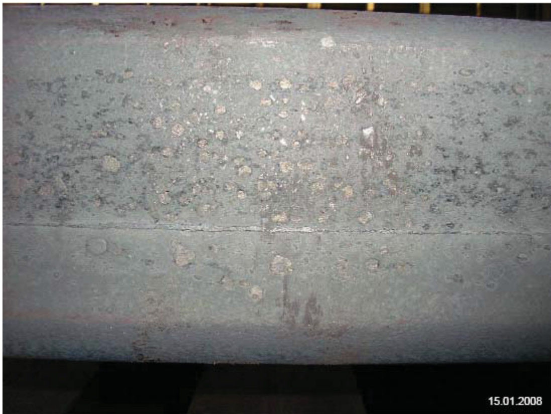
Bild 55: Zundergefüllter Flächenlängsriss, Stahlgruppe 2
