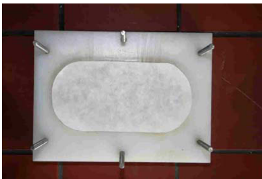
Abbildung 43: Austausch des Filterpapiers im unteren Strömungsbereich
