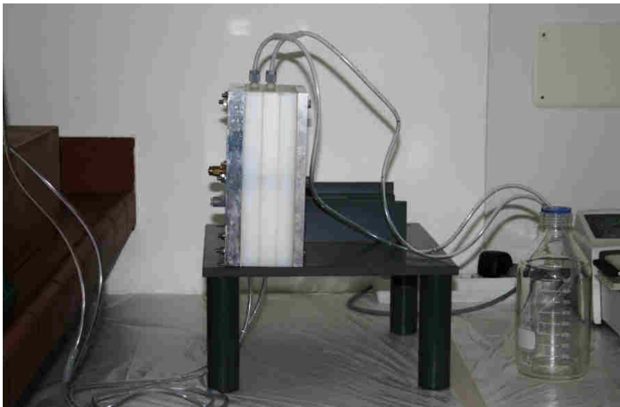
Abbildung 39: Entlüften des Permeameters in vertikaler Position
