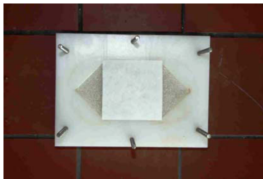
Abbildung 43: Austausch des Filterpapiers im unteren Strömungsbereich
