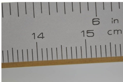
Abbildung 44: Aufnahme zur Ermittlung des Abbildungsmaßstabes
