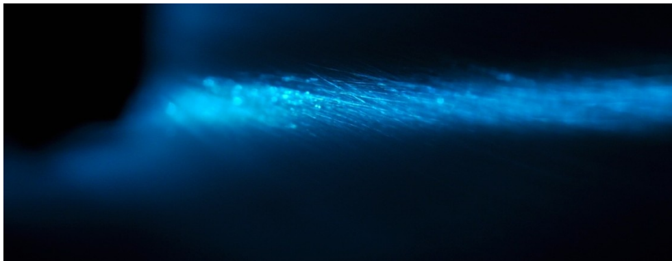
Abbildung 60: Partikel unmittelbar nach der Düse mit Laserstrahl belichtet
