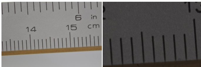
Abbildung 45: Bild links: ohne ZR; Bild rechts: mit 136 [mm] ZR
