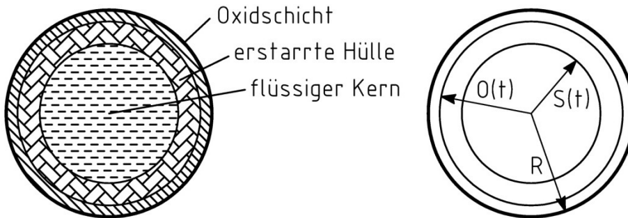
Abbildung 80: Oxidschicht, feste und flüssige Regionen eines Schmelzetropfens (links); Ortsangabe der einzelnen Trennflächen (rechts) nach Delplanque et al.[35]
