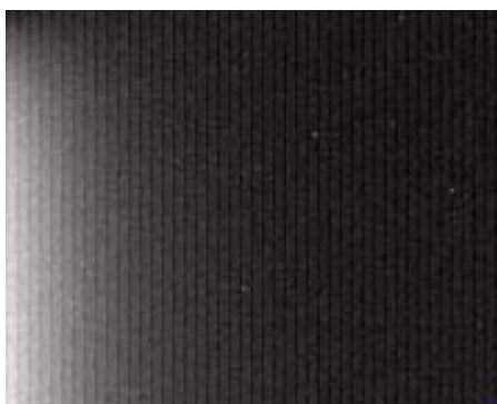
Abbildung 36: Dunkelstromeffekt aufgrund Erwärmung durch linksseitig liegenden Ausleseverstärker [28]
