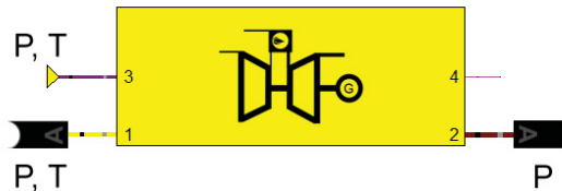
Abbildung 5.9: Randbedingungen der Gasturbinenmodule
