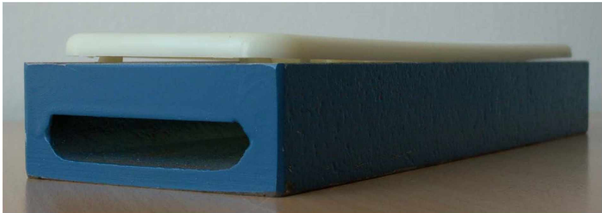
Abbildung 22: Verzug des Formteiles Signalblende
