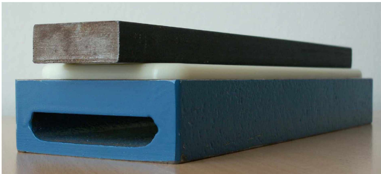
Abbildung 23: Verzug eliminiert durch Messauflage und Gewicht
