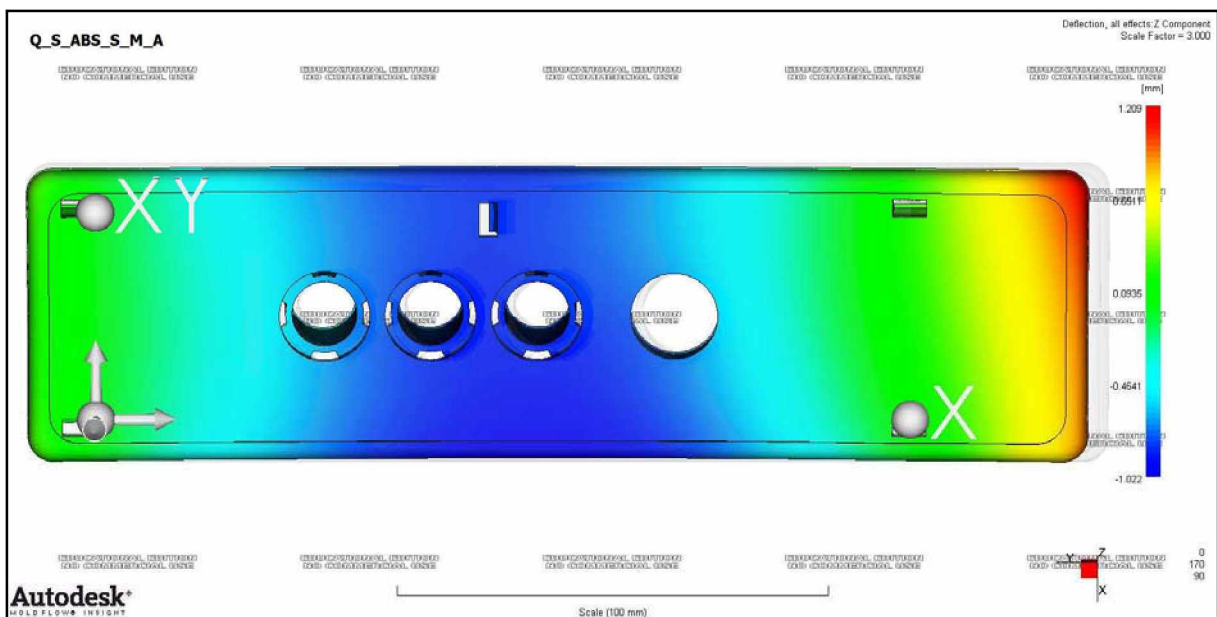
Abbildung 26: Lokales Koordinatensystem und Verzug des Formteiles; Verzugswerte um den Faktor 3 vergrößert dargestellt; Beispiel Q_S_ABS_S_M_A
