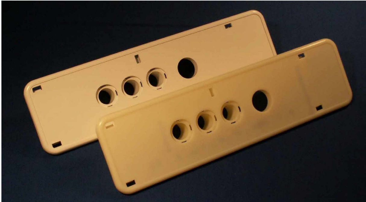
Abbildung 12: Signalblende aus Novodur P2H-AT; im Hintergrund Material I, im Vordergrund das neuere Material II
