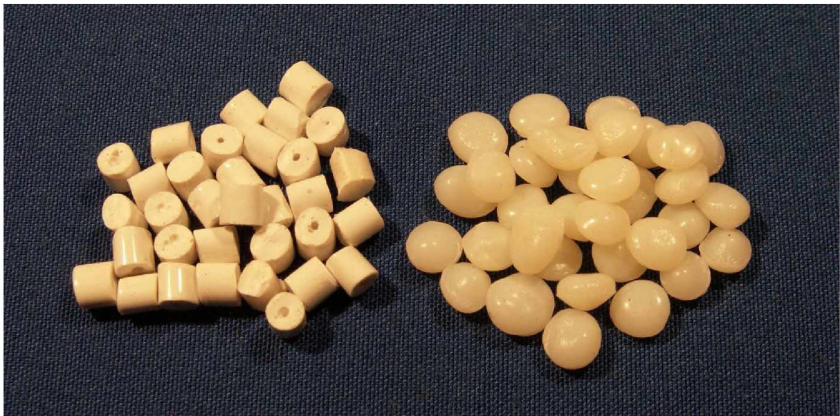
Abbildung 13: unterschiedliche Granulattypen des Novodur P2H-AT; früheres Material links (I) und Neuware rechts (II)
