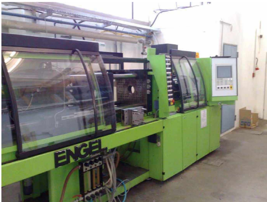
Abbildung 14: Spritzgießmaschine Engel ES330/80H
