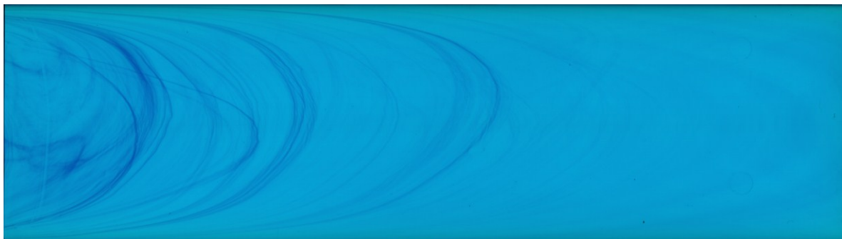
(3) Plättchen geschliffen mit Meteringteil bei 246 U/min
