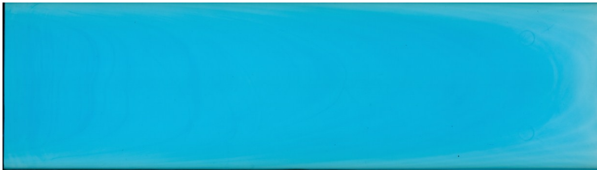
(2) Plättchen geschliffen mit Rautenmischteil bei 200 U/min
