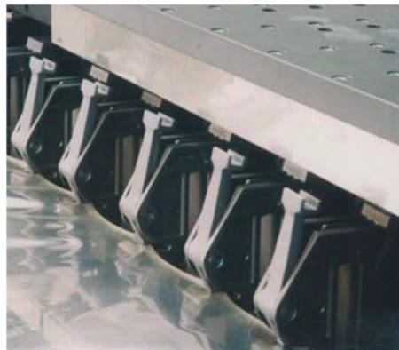
Abb. 9: Kluppen der LISIM ® , die einen PET-Film aufgreifen [13]
