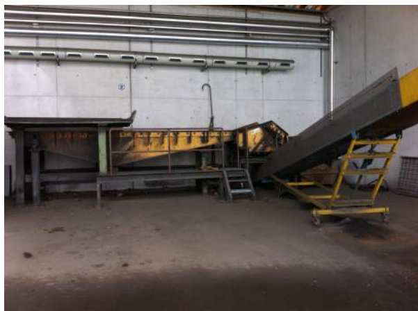
Abbildung 5.7: Siebanlage zur Klassierung des Kokes
