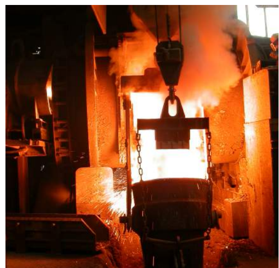
Abbildung 4.2: Abguss am Konverter
