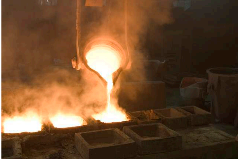
Abbildung 4.6: Abguss von Kupferblöcken
