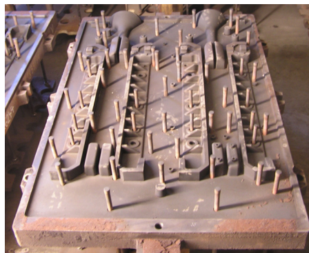
Abbildung 4: Modellplatte mit Gießtechnik und Gussteil 40
