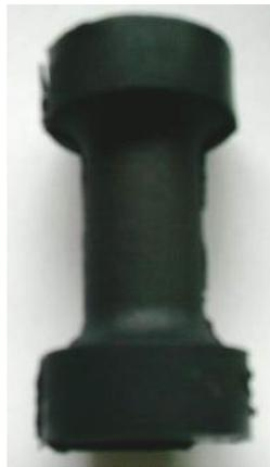
*Abbildung 12: Hantelprüfkörper*
