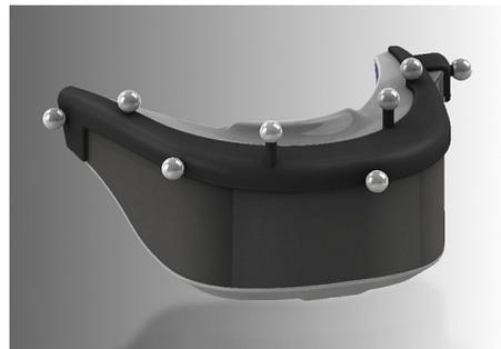
Abbildung 4.6: ART Marker auf Head Mounted Display<sup>1</sup>
