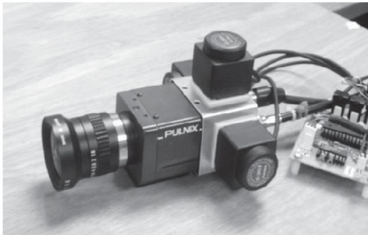
Abbildung 3.5: Kamera mit angebrachten Gyroskopen [Kle06]
