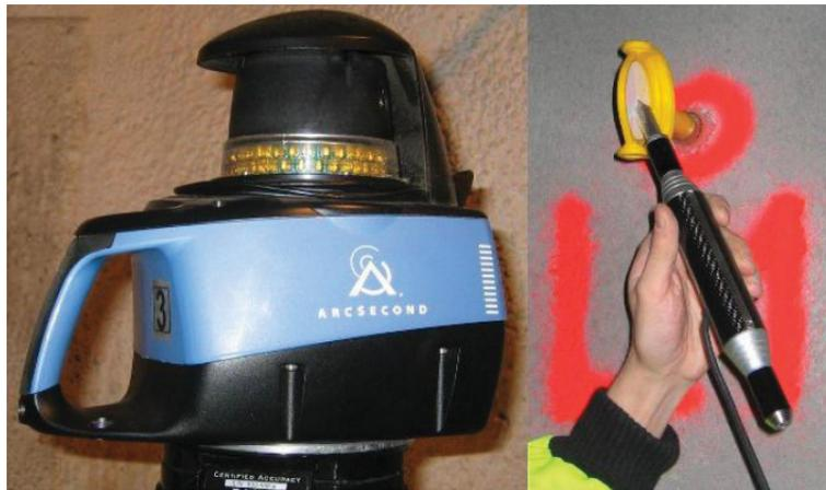
Abbildung 3.15: iGPS Transmitter und Sensor [Mau09]
