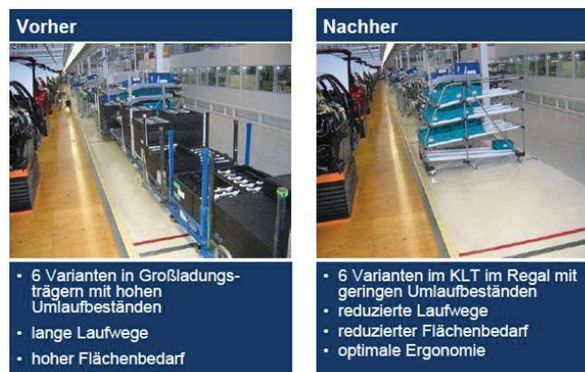
Abbildung 26: Bereitstellung von Kleinladungsträger an der Linie<sup>72</sup>
