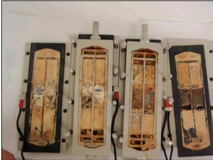
Abbildung 25: Verkalkte Platin- und Mischoxidelektrode nach 28 Tagen Versuchsdauer
