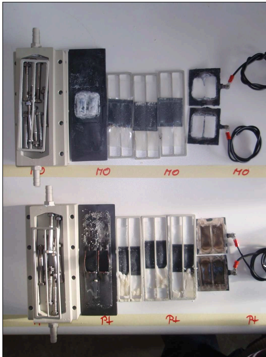
Abbildung 29: MO- und Platinelektroden nach den Langzeitversuchen
