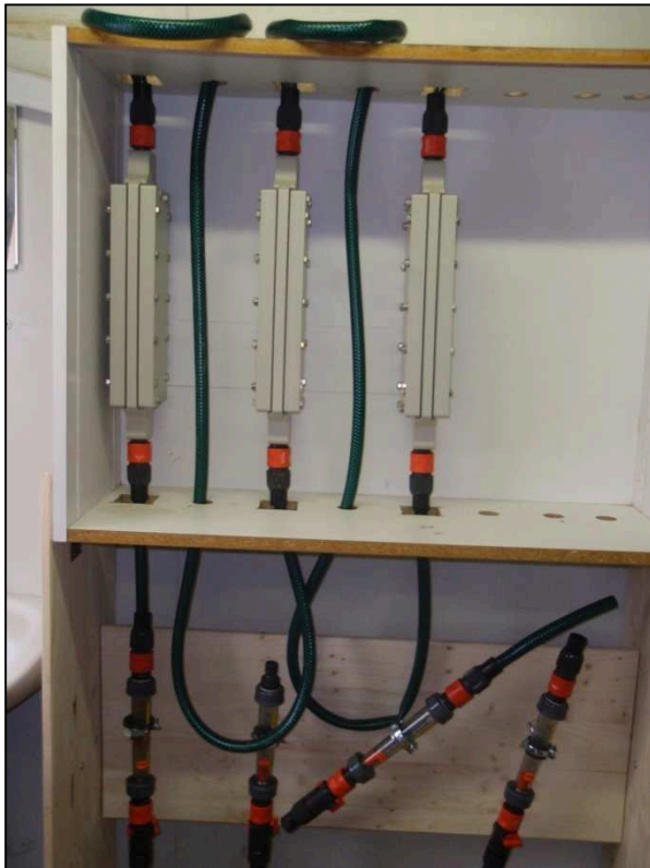
Abbildung 30: Durchflussmesser und Reaktorzellen mit Stecksystem
