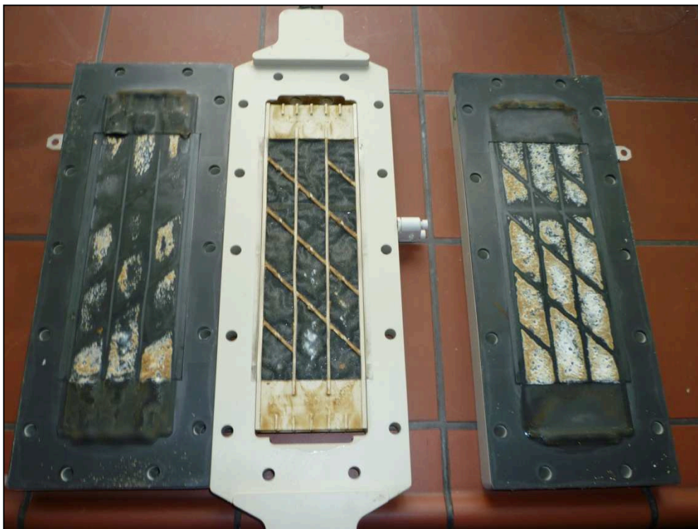
Abbildung 49: Verkalkung der Elektroden
