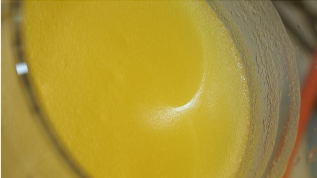
Abbildung 5-14: Ungewaschener Rückstand nach der Laugung in einer Glasfritte
