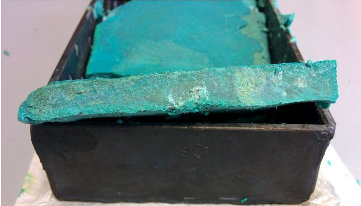
Abbildung 5-22: Bruchfläche der erstarrten Schmelze
