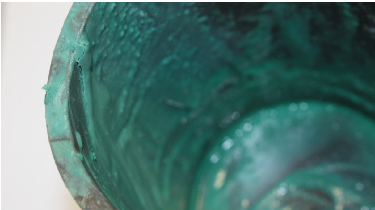
Abbildung 5-8: Tiegel mit Rückständen nach dem Entleeren
