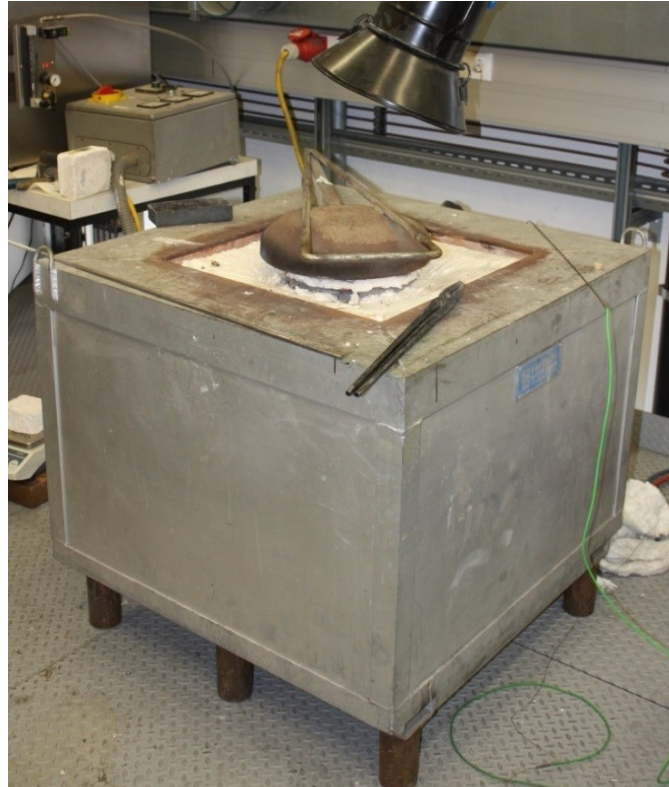
Abbildung 5-3: Verwendeter Widerstandsofen für den Schmelzaufschluss
