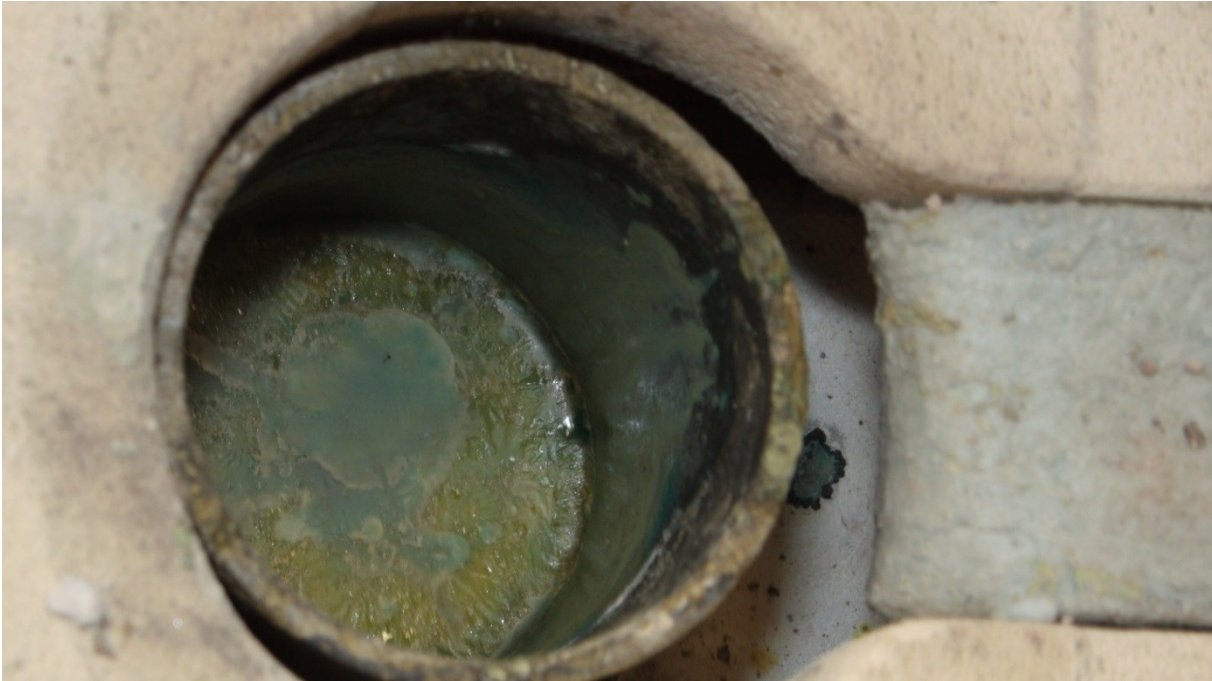
Abbildung 5-21: Alkalische Schmelze im flüssigem Zustand (Versuch L4)
