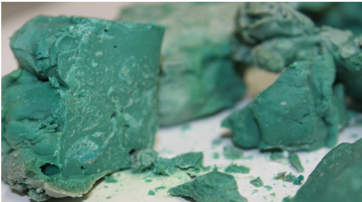
Abbildung 5-17: Querschnitt der erstarrten Schmelze
