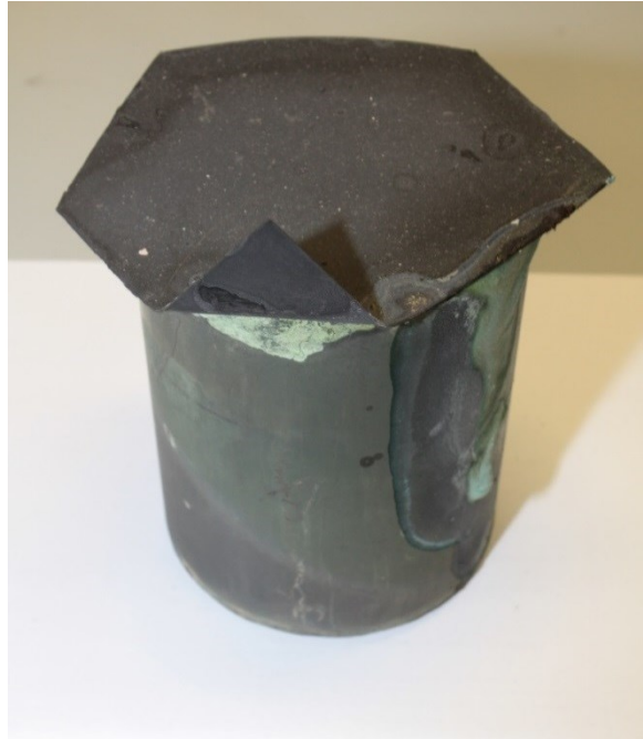
Abbildung 5-7: Nickeltiegel mit Abdeckung
