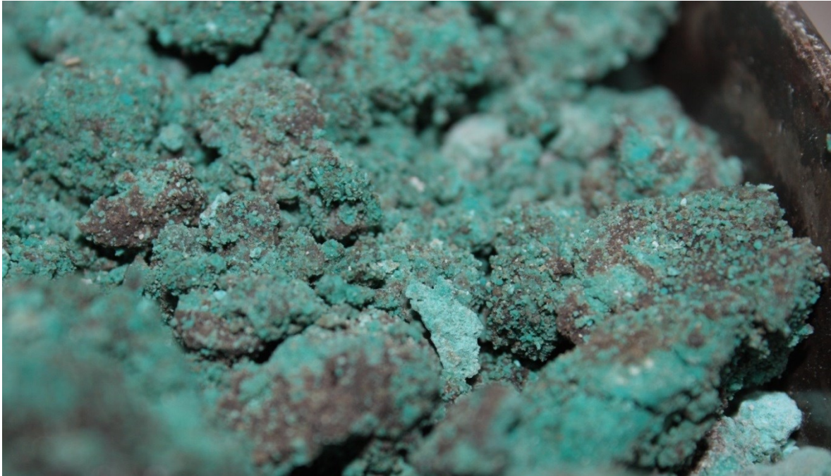
Abbildung 5-24: Abgekühlter Abguss aus dem Na 2 CO 3 -Aufschluss
