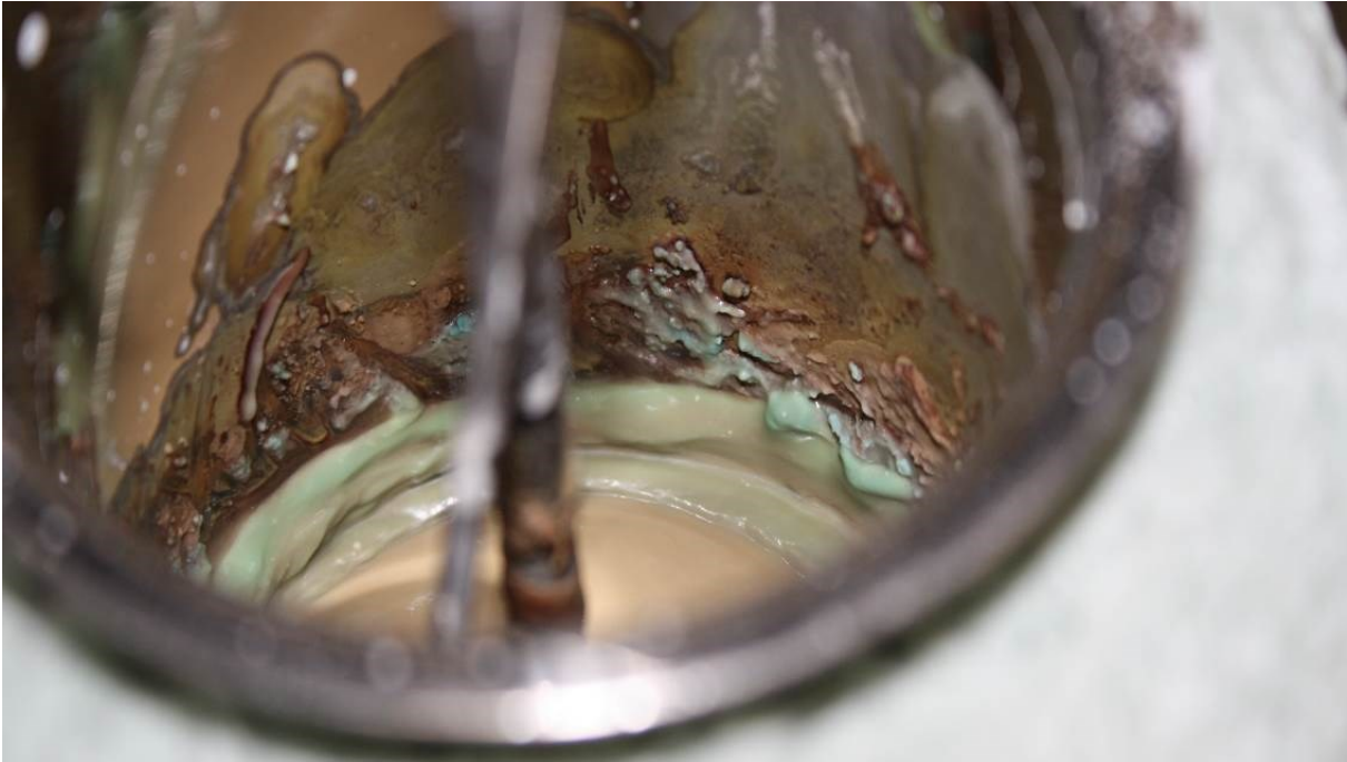
Abbildung 5-2: Tiegel mit Schmelze bestehend aus Leuchtstaub und eutektischer Salzmischung
