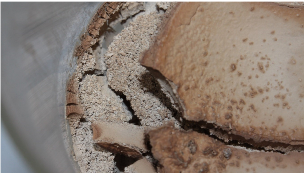
Abbildung 5-26: Grobkörniger und getrockneter Filterrückstand nach der Heißlaugung
