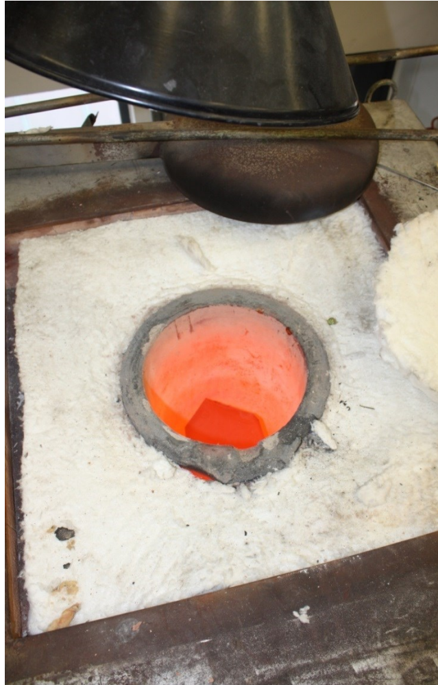
Abbildung 5-5: Darstellung des Tiegels im Ofenbetrieb
