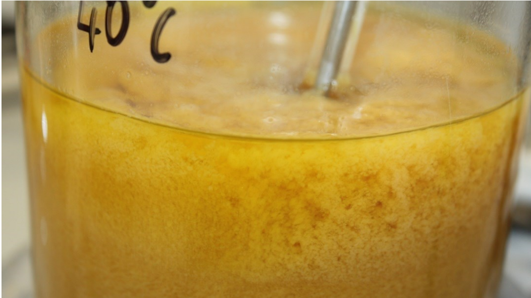
Abbildung 5-18: Entstandene gallertartige Masse bei einer Laugungstemperatur von 40 °C
