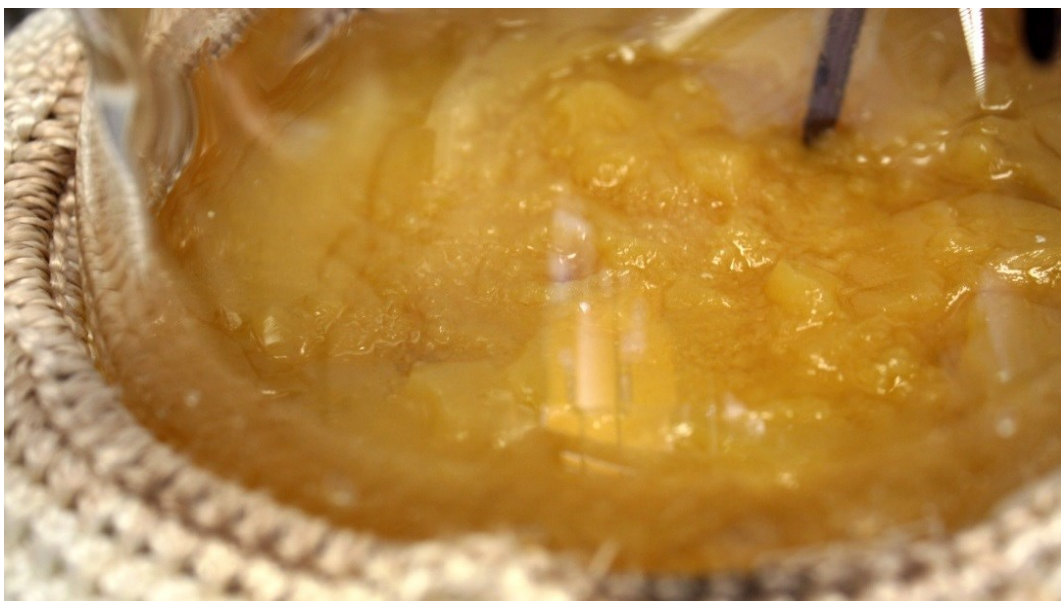
Abbildung 5-19: Entstandene gallertartige Masse bei einer Laugungstemperatur von 80 °C
