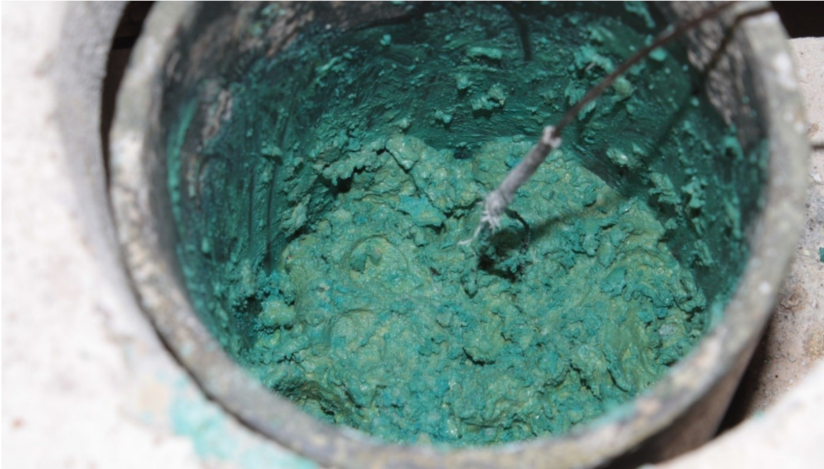
Abbildung 5-25: Tiegel im Ofen mit Thermoelement und hochviskoser Schmelze
