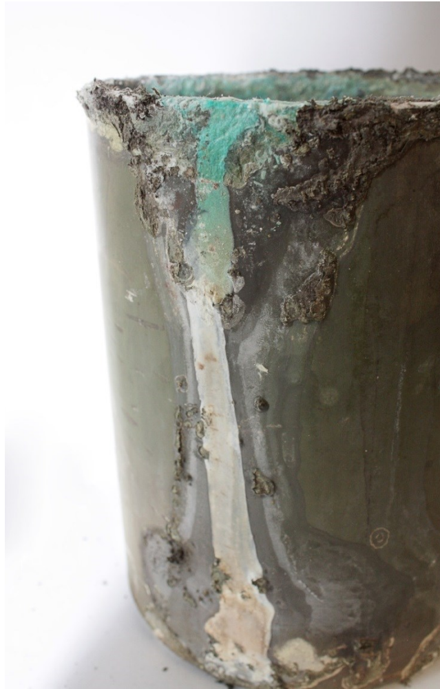
Abbildung 5-29: Tiegel nach dem Abguss mit anhaftenden Alkalien
