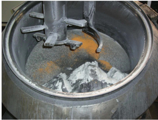
Abbildung 26: Mischaggregat für die Steinherstellung.
