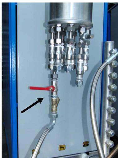
Abbildung 3.21: Kugelhahn zur Regelung der Kühlung.
