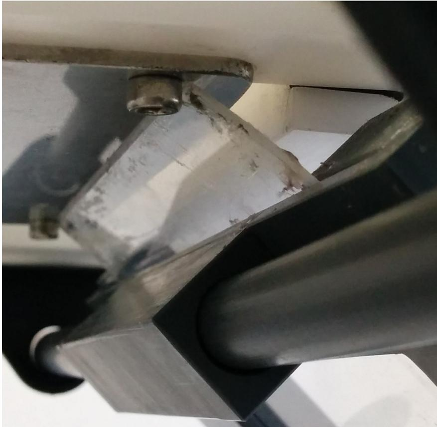
**Abbildung 39 - Seitliche Undichtigkeitsstelle**
