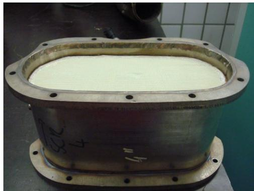
Abbildung 9: Brick in einem Wechselcanning
