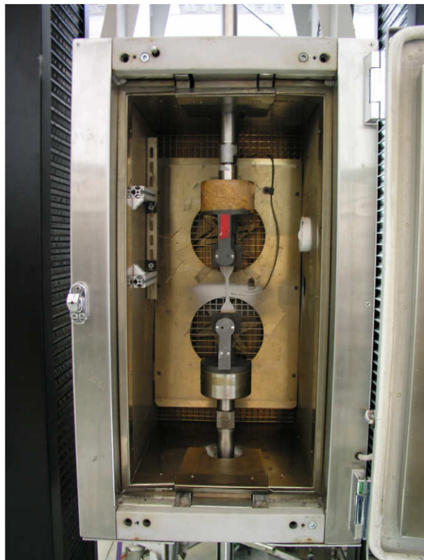
Abb 4.6: Ein Prüfkörper in der Klimakammer der Instron 5500.
