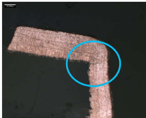
Abb. 6.37: Gefundener Anriss in einem Prüfkörpers des Modells A-0,8; Materialien 1/2. (Austria Technologie und Systemtechnik AG, Leoben.)
