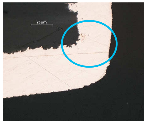
Abb. 6.35: Gefundener Anriss in einem Prüfkörper des Modells A-0,5; Materialien 1/2. (Austria Technologie und Systemtechnik AG, Leoben.)
