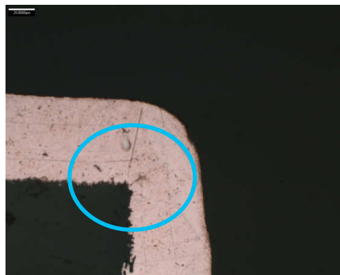
Abb. 6.42: Gefundener Anriss in einem Prüfkörpers des Modells B-0,8; Materialien 1/2. (Austria Technologie und Systemtechnik AG, Leoben.)
