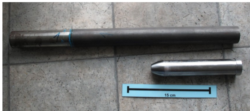
Abbildung 3-29: Geklebte Rohrzugprobe mit Einsatzstück.
