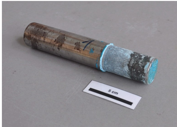
Abbildung 4-60: Probe mit 54 mm geklebter Länge und Streakshape Oberfläche.
