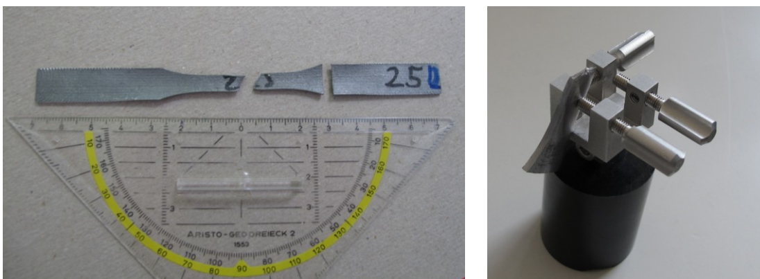
Abbildung 3-25: Zugprobe und Analyseaufbau.
