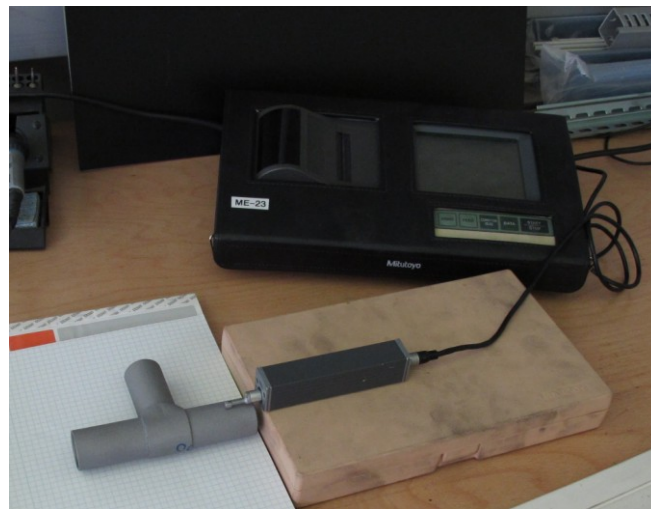
Abbildung 3-19: Messaufbau für Rauigkeitsmessung.
