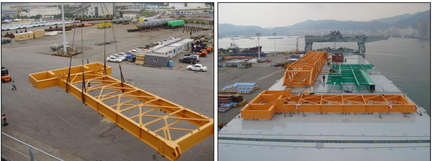
Abbildung 12: Gegengewichtsausleger Projekt Port Waratha Australien (Abbildung Sandvik)
