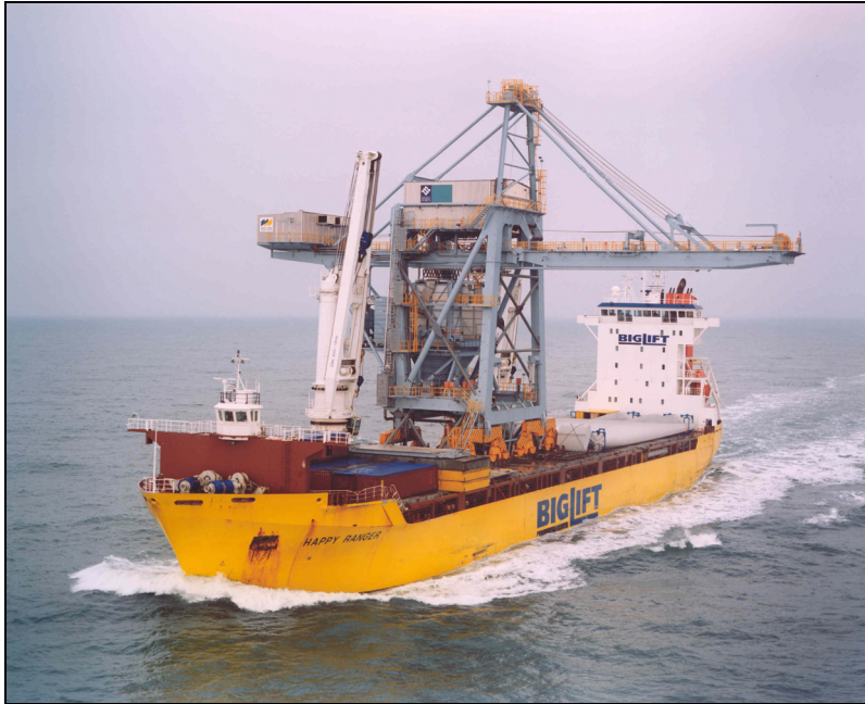
Abbildung 6: Verschiffung einer kompletten Maschine (Shipunloader Projekt Yarwun Sept. 2009)
