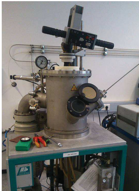
Abbildung 3-1: Lichtbogenofen zur Herstellung der AlTa20-Legierung.
