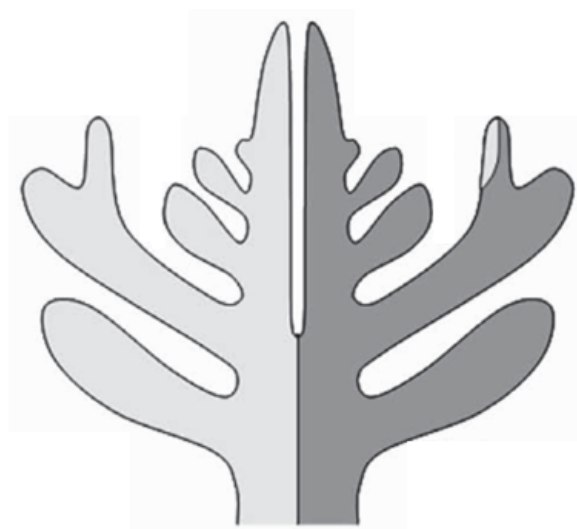
Abbildung 2-12: Zwillingsdendrit mit einem flüssigen Kanal, der in das Stammzentrum ragt und dort erstarrt [17].
