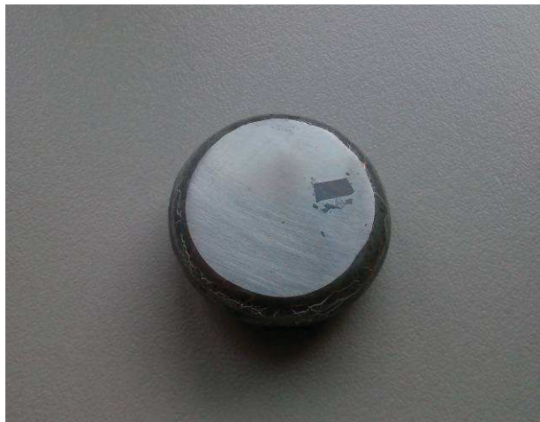
Abbildung 4-27: AlTa13-Legierung nach 4maligem Aufschmelzen: Ta-Phasen haben sich noch nicht gelöst.
