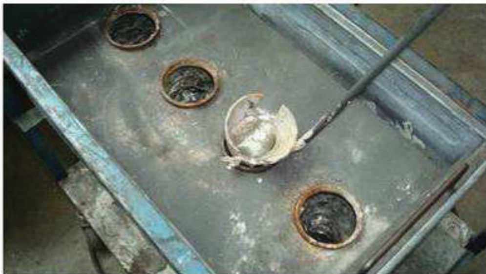
Abbildung 3-9: Testvorrichtung mit Kelle nach ASTM TP1-Standardtest.
