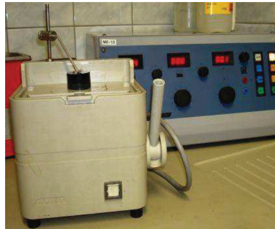
Abbildung 3-12: Elektrolytisches Ätzgerät, ATM Kristall 620 mit externer Elektrolytzelle.
