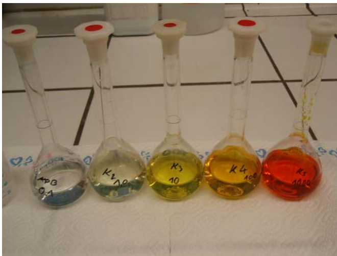
Abbildung 3.2: Verdünnungsreihe der Chromatlösung
