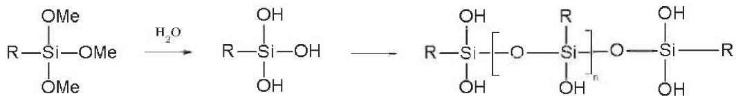
Abbildung 2.10.: Vernetzung von Alkoxysilanen
