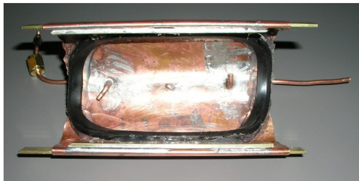
Abb. 3.23: Kupferblech-Halbschale als In-Situ-Permeationskammer.
