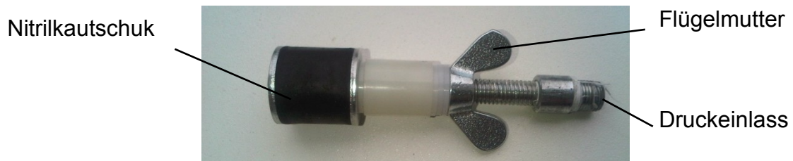
Abb. 3.5: Neues Prüfrohr-Endkappensystem (Firma SUS GmbH, Schwerin).
