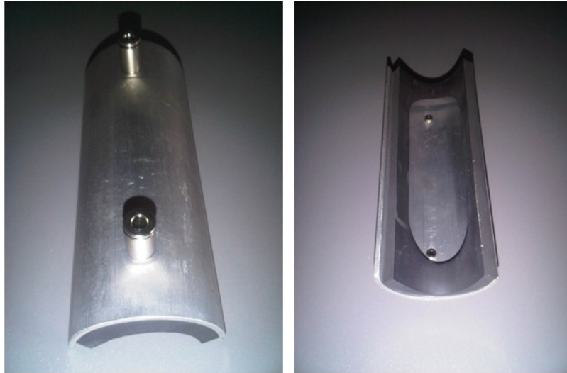
Abb. 3.22: Aluminium-Halbschale als In-Situ-Permeationskammer; Aussenansicht (links); Innenansicht (rechts).
