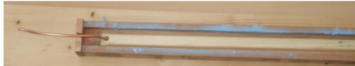
Abb. 3.18: Gussform aus Holz für die Fertigung des flexiblen Ringraums.
