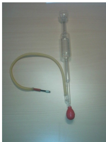
Abb. 3.9: HP-„ Soap-Film-Flowmeter “ zur Messung aller Gasflüsse am GC HP-5890.
