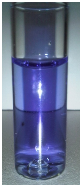
Abb. 3.7: Extraktion des organischen Permeats aus 1ml wässrigen Sammelmedium mit Hilfe von 80 \mu l Chloroform, als Kontrastmittel wurde Bromthymol-Blau eingesetzt.
