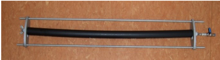
Abb. 3.6: Widerlager für ein druckbeaufschlagtes Rohr, um ein Austreiben der Prüfrohr-Endkappen zu verhindern.
