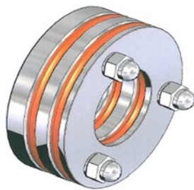
Abb. 3.3: Optimiertes Dichtsystem für Kunststoffrohre mit 32mm Aussendurchmesser: CAD-Zeichnung (links) und Fotografie im eingebauten Zustand (rechts).
