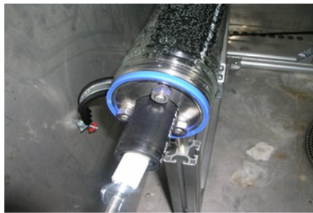
Abb. 3.3: Optimiertes Dichtsystem für Kunststoffrohre mit 32mm Aussendurchmesser: CAD-Zeichnung (links) und Fotografie im eingebauten Zustand (rechts).
