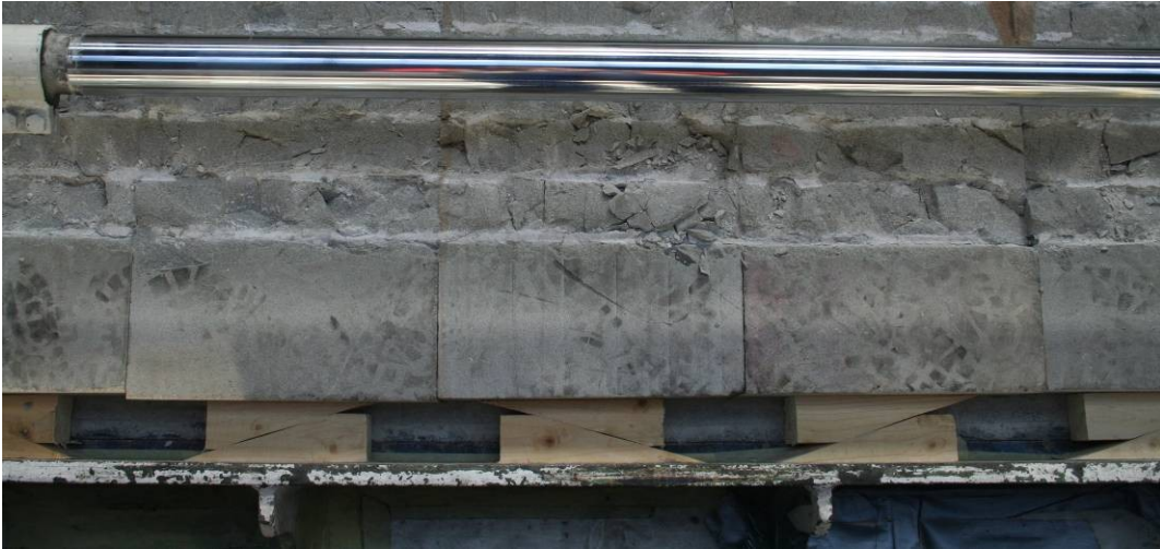
Abbildung 25: Eingebrachte Holzkeile zur Seitenstützung der 60-iger-Blöcke
