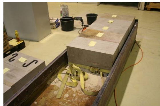
Abbildung 27 : Einbau der 60-iger-Blöcke mit Spanngurteinsatz
