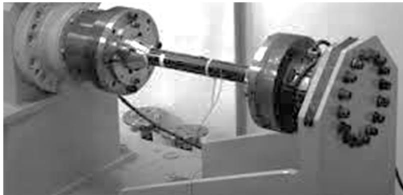
Abb. 2.10: Beispielhafte Darstellung eines Torsionsprüfstandes (Kimoto et al., 2011).
