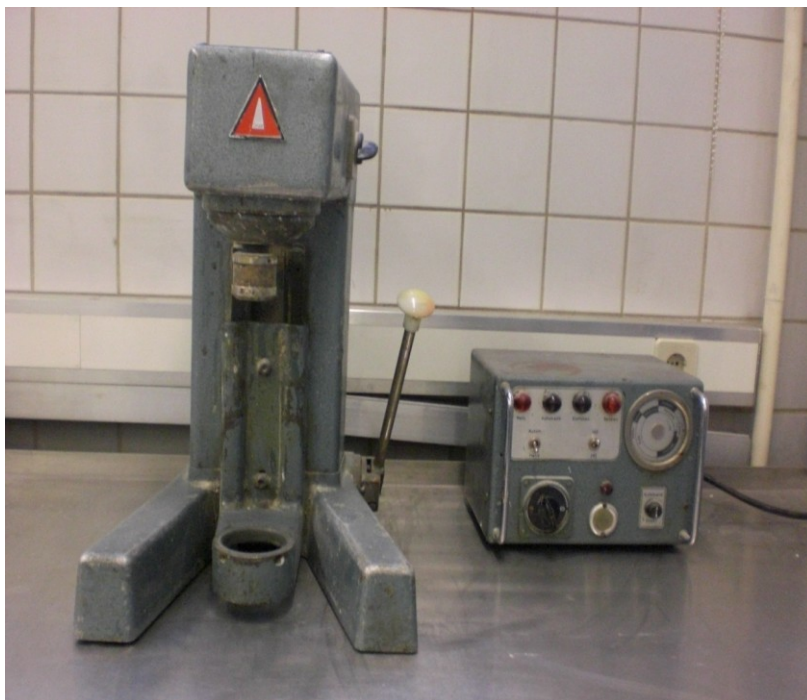
Abbildung 7: Darstellung des Mörtelmischer nach ÖNORM 196-1
