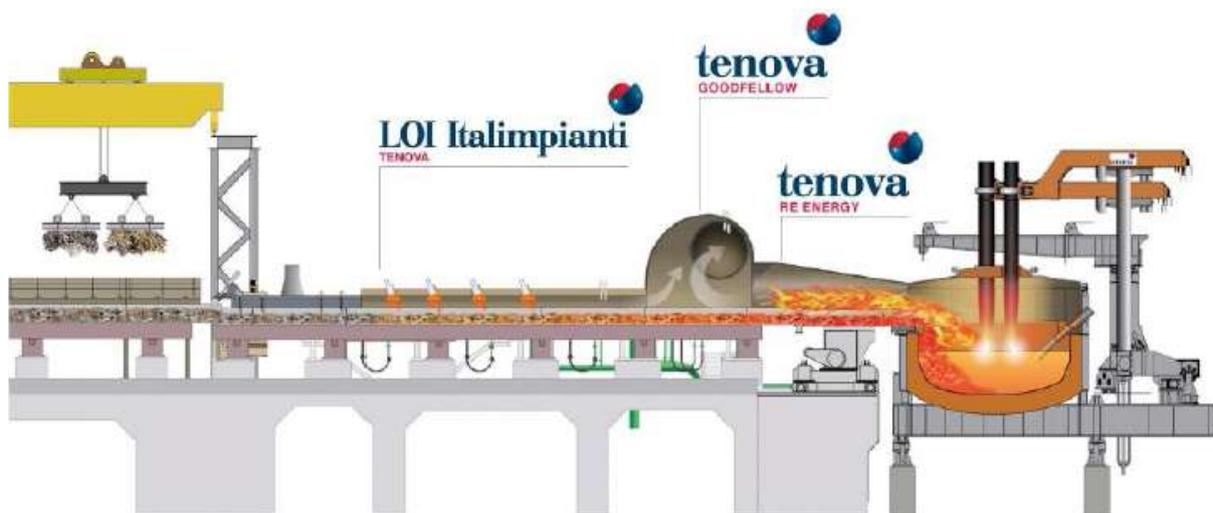
**Abbildung 4-17:** Schematische Darstellung des Consteel Evolution™ [41].
