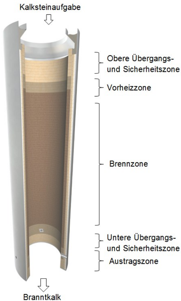
Abb. 4: Normalschachtofen für die Herstellung von Branntkalk [7].
