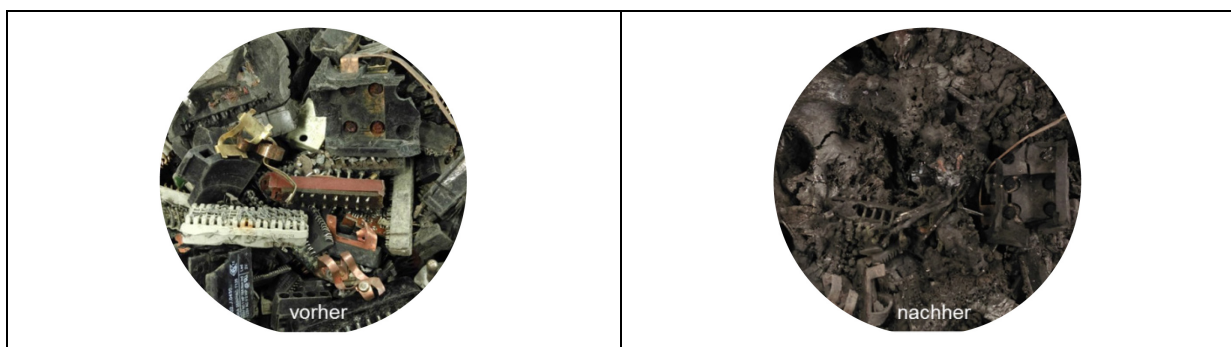
Abbildung 14-24: Veränderung des Probenmaterials durch die Pyrolyse – Kontakte – Batch 3
