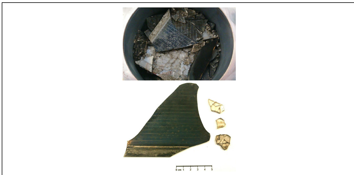
Abbildung 14-28: PV-Modul nach der thermischen Behandlung – beschichtetes Glas (links unten), unbeschichtetes Glas (rechts unten) [61]
