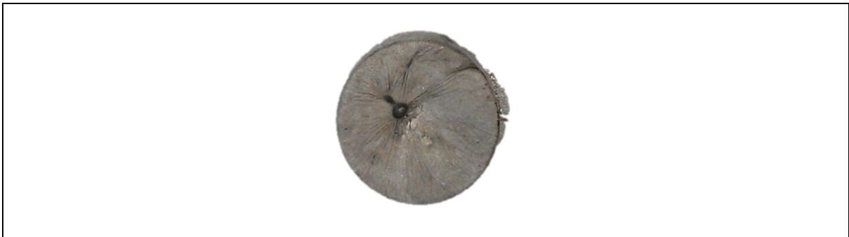
Abbildung 6-18: Probenregulus aus dem Schmelzversuch zur Fraktion F7Z – Batch 1
