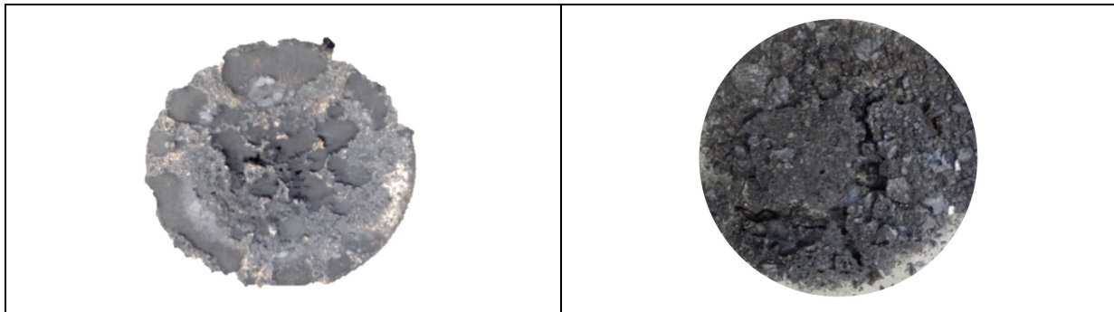
Abbildung 14-15: Regulus (links) und Schlacke (rechts) aus dem Schmelzversuch zur Fraktion D6 – Batch 2
