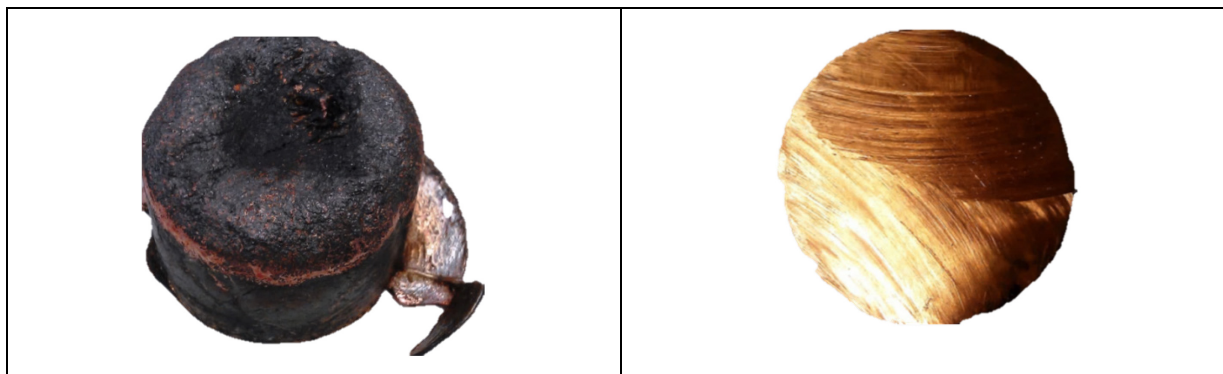
Abbildung 6-12: Probenregulus (links) und Querschnitt (rechts) aus der Fraktion D16-2 – Batch 1
