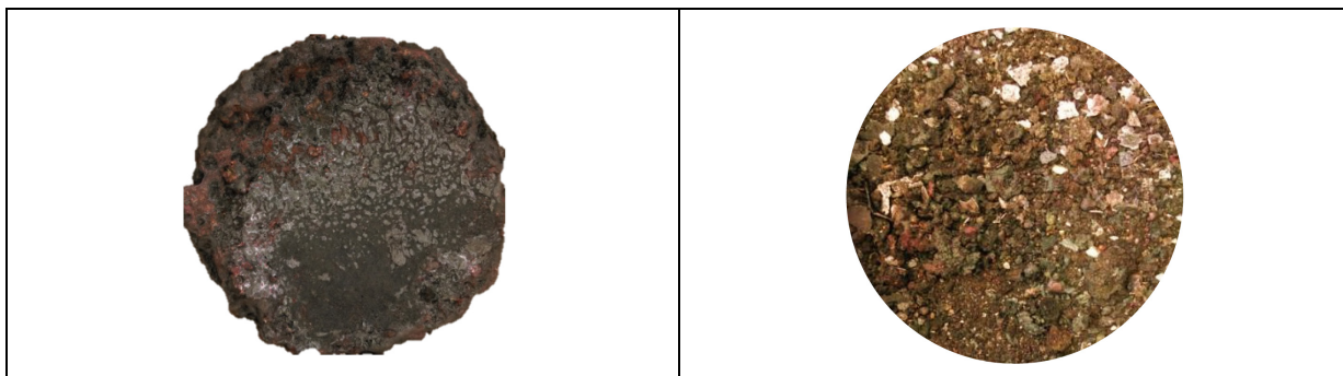
Abbildung 14-22: Probenregulus (links) und Schlacke (rechts) aus der Probe E6 – Batch 3
