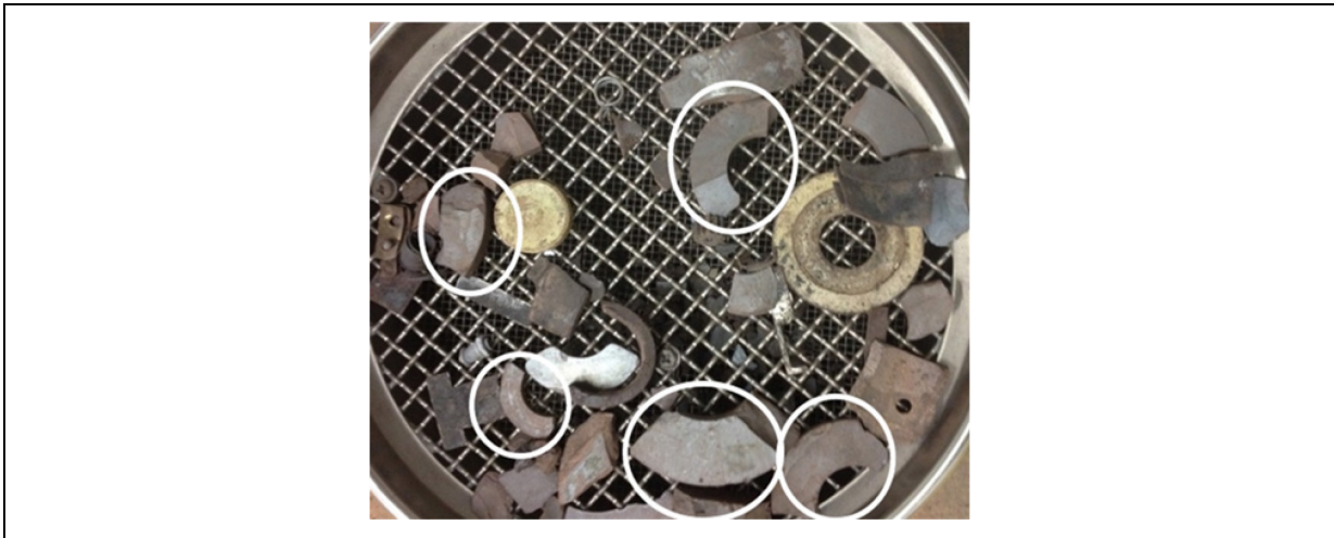
Abbildung 6-4: Siebfraction > 6,3 mm mit anschließender händischer Sortierung der Magnetmaterialien (weiß)
