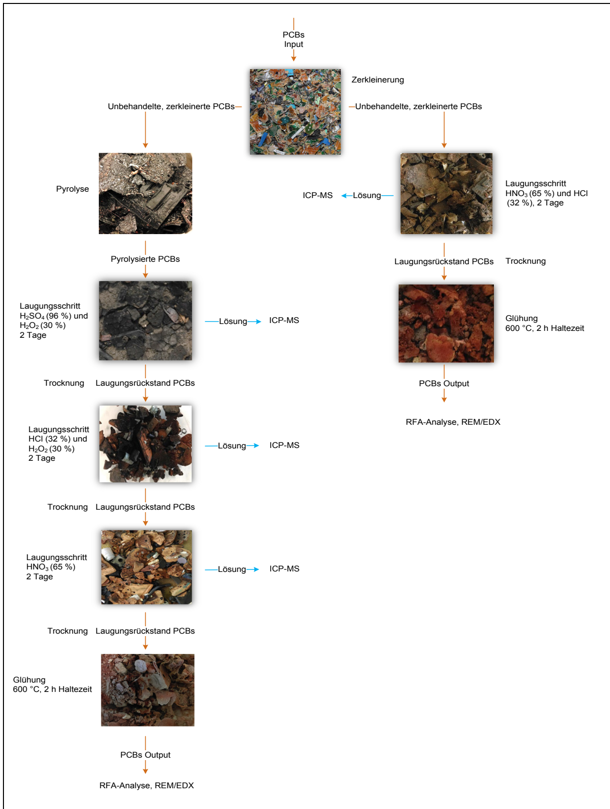
Abbildung 6-32: Durchführung der Charakterisierung von Leiterplatten
