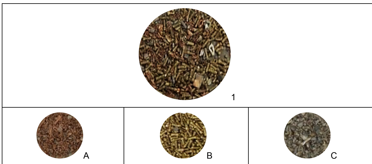
Abbildung 6-24: Ausgangsmaterial (1) und daraus optisch sortierte Fraktionen (A-C) der Probe aus der Fraktion D18 – Batch 2
