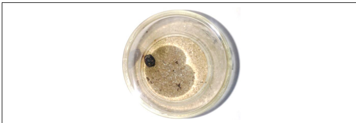
Abbildung 14-11: Laugungsrückstand einer mit Königswasser aufgeschlossenen Probe aus der Fraktion D30 – Batch 1
