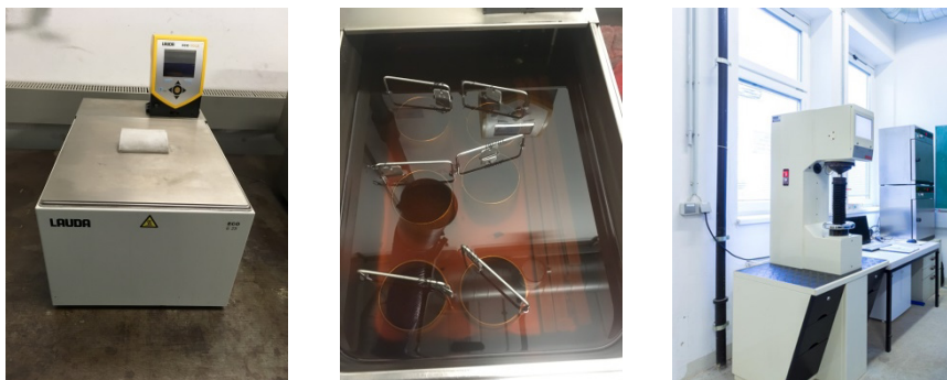
Abbildung 6-4: Umwälzthermostat LAUDA ECO E25 (links), Edelstahl-Probenkörbe im Ölbad (mitte), EMCO Universalhärteprüfmaschine M4C/RG3 [40] (rechts)
