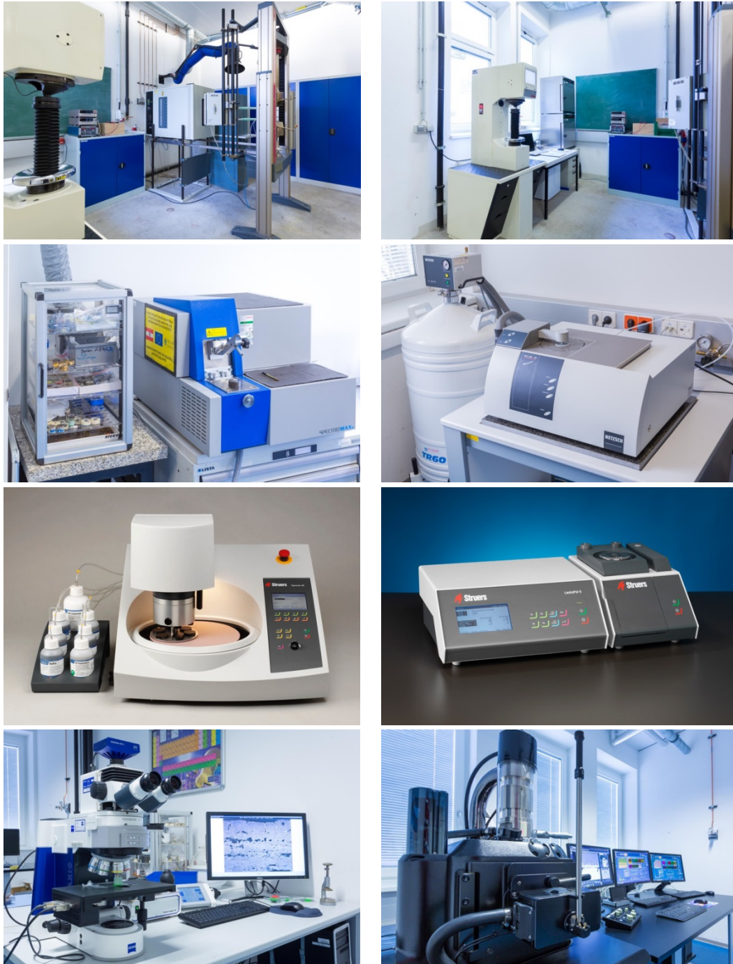
Abbildung 13-1: Verwendete Gerätschaften von links oben nach rechts unten; Zwick-Roell Material-Prüfmaschine 100KN, EMCO Universalhärteprüfmaschine M4C/RG3, Funkenspektrometer SpektromaxX, Netzsch Tieftemperatur-DSC 204 F1, Poliermaschine Struers Tegramin 30, elektrolytisches Ätz- und Poliergerät Lectropol-5, Auflichtmikroskop Zeis Imager M1M, Rasterelektronenmikroskop Jeol JSM-IT30 [40]
