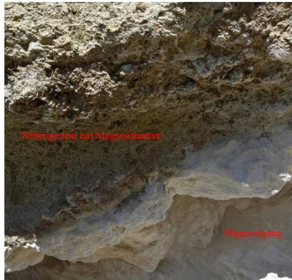
Abb. 5.14.: Kontaktbereich des Magnesitgange mit Serpentinitt bei HEN 17 Bildbreite 60cm
