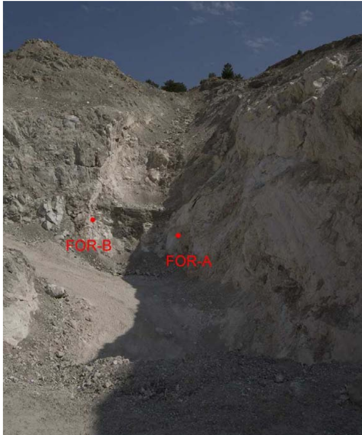
Abb. 5.20.: Gangstruktur mit 2 Probenahmepunkten bei FOR 48 und einer Gangmächtigkeit 5-6m. Das Einfallen der Struktur ist 284/89. Blickrichtung Norden
