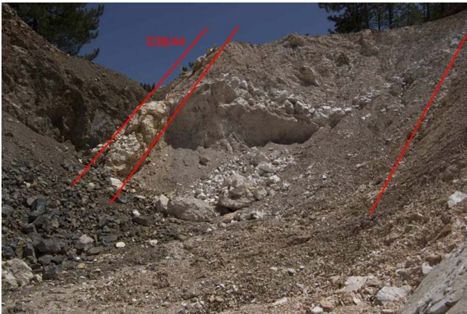
Abb. 5.91.: Mittlerer Abbaubereich von Tilkiini mit Störungen(038/44 und 027/67).
