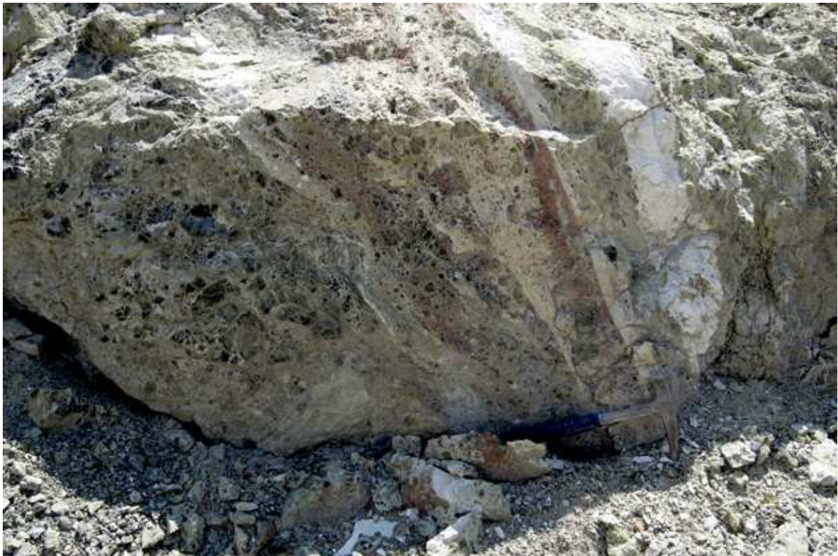
Abb. 5.56.: Serpentinbrezie im zentralen Bereich (Höhe der ersten Abbauterrasse) der Scherzone mit rot bzw. grüngefärbter Magnesitmatrix
