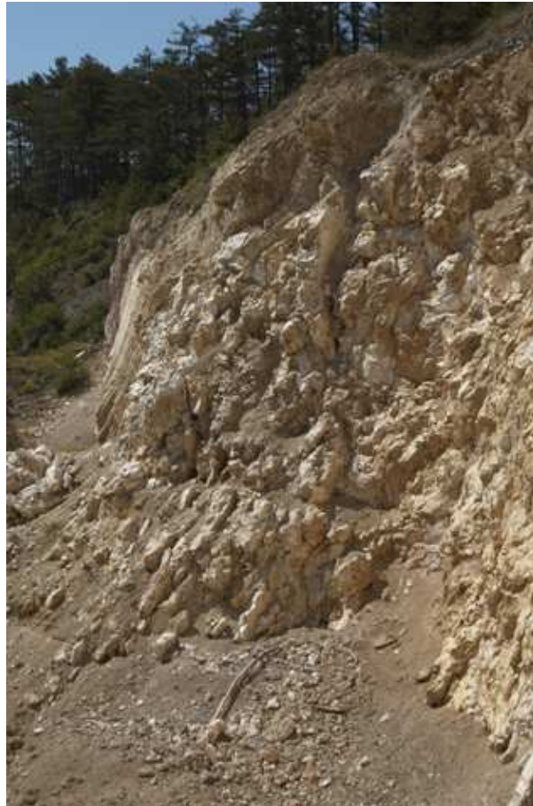
Abb. 5.87.: Detailaufnahme des Ganges bei Kurtini (Gangbreite 4-5m). In der Bildmitte ist gut der stehengelassene Teil mit den zu hohen Werten an \text{SiO}_2 zu erkennen.
