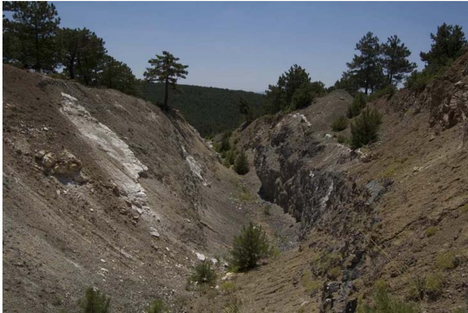
Abb. 5.40.: Hauptabbaugebiet bei Aksu mit N-S streichender Störung (Schurfbreite 6-8m)
