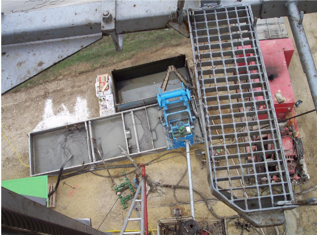
Abbildung 43: Benötigte Obertageeinrichtungen zur Aufbereitung der Spülung bei Bohrungen mit Behandlungswinden
