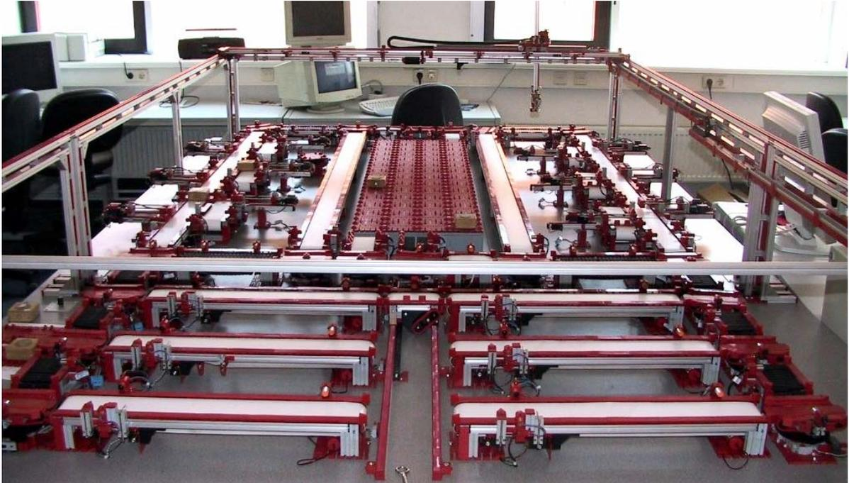
**Abbildung 23** Stückgutförderanlage aus Fischertechnik der Uni Magdeburg<sup>58</sup>
