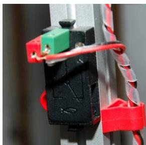
**Abbildung 7** Fischertechnik-Positionsschalter
