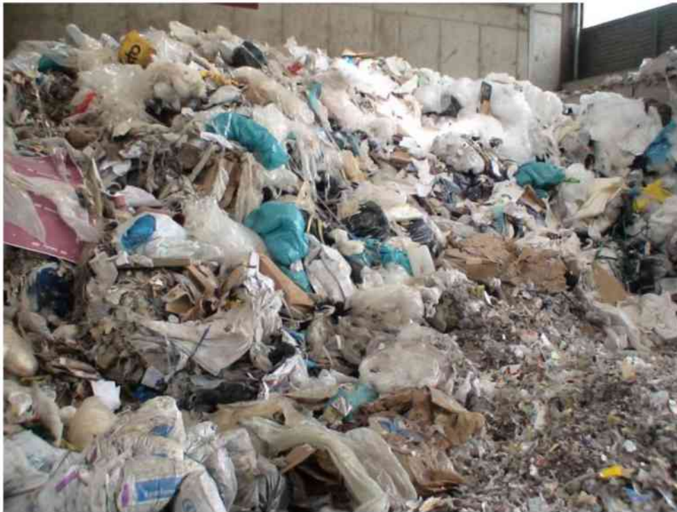
Abbildung 13: Überdachter Flachbunker mit Boxen zur Zwischenlagerung angelieferter Inputfraktionen
