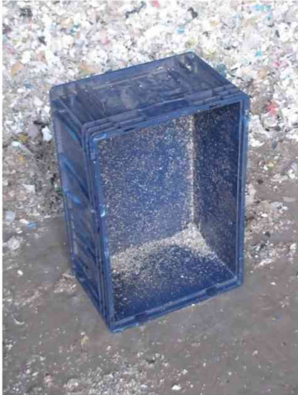
Abbildung 29: Probenahmebehälter mit den Abmessungen (L)54x(B)24x(T)35 cm für Reject-Haufen
