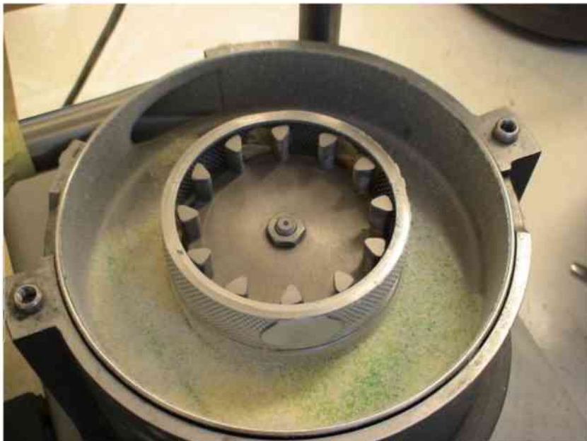
Abbildung 3: Zentral angeordneter Rotor mit keilförmigen Rotorzähnen und Ringsieb
