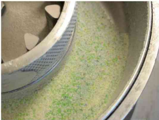
Abbildung 63: Innenraum der Ultra-Zentrifugalmühle mit Rotorzähnen, engmaschigen Siebring und aufbereitetem PET-Granulat
