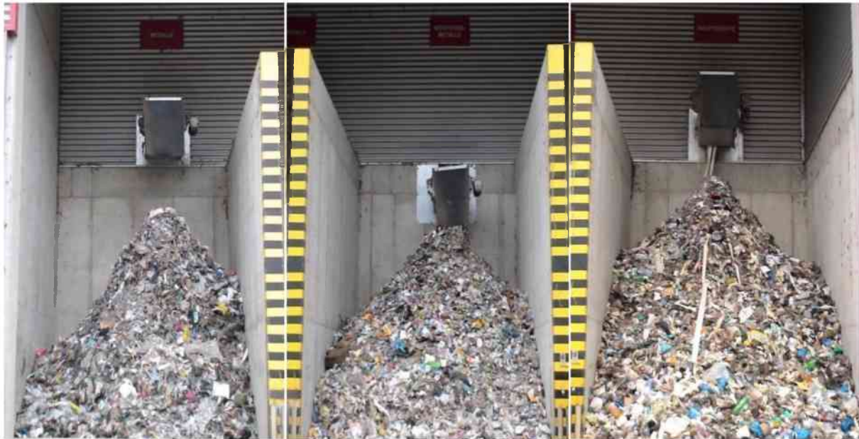
Abbildung 21: Austragsboxen für v.l.n.r. Metall-, Nichtmetall-, Inertstoffe
