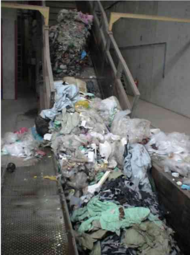
Abbildung 17: Aufgabebereich zur Vorzerkleinerung
